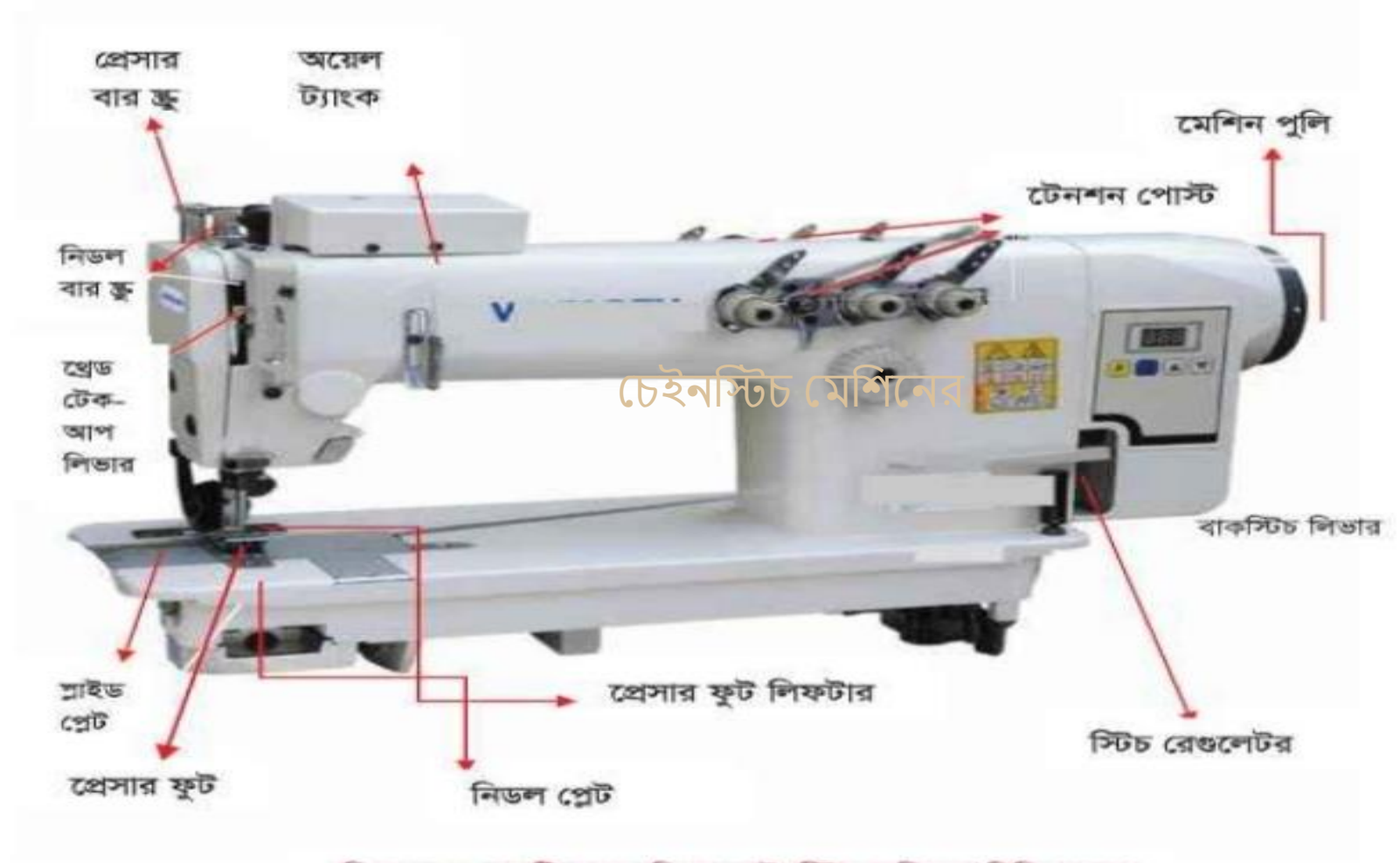
চিত্র : ২.৩ একটি ডাবল নিডল চেইনস্টিচ মেশিনের বিভিন্ন অংশ
