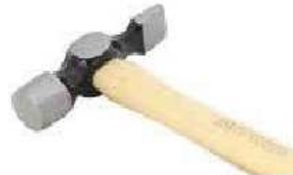
চিত্র -২.৩১ ক্রসপিন হ্যামার Cross Pin Hammer
