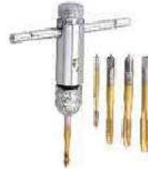
চিত্র-২.২৫ ট্যাপ হোল্ডার এবং ট্যাপ Tap Holder and Tap
