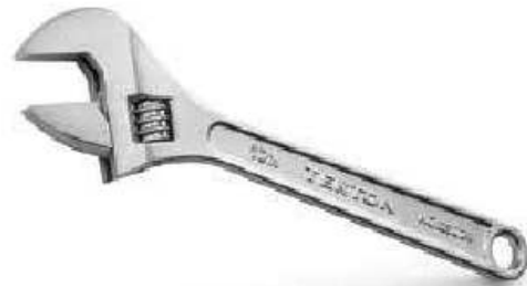
চিত্র -২.৪৯ এডজাস্টেবল রেঞ্জ Adjustable Wrench
