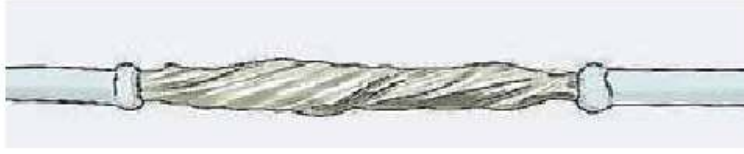
চিত্র: ৪.১৪ তারের সোন্ডারিং বা ঝালাই
