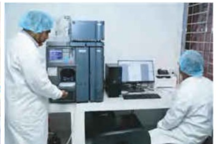
চিত্র-৭ (২)ঃ রেসিডিউ ও বায়োলজিকস শাখায় High-Performance Liquid Chromatography (HPLC) মেশিন দ্বারা নমুনা পরীক্ষা
