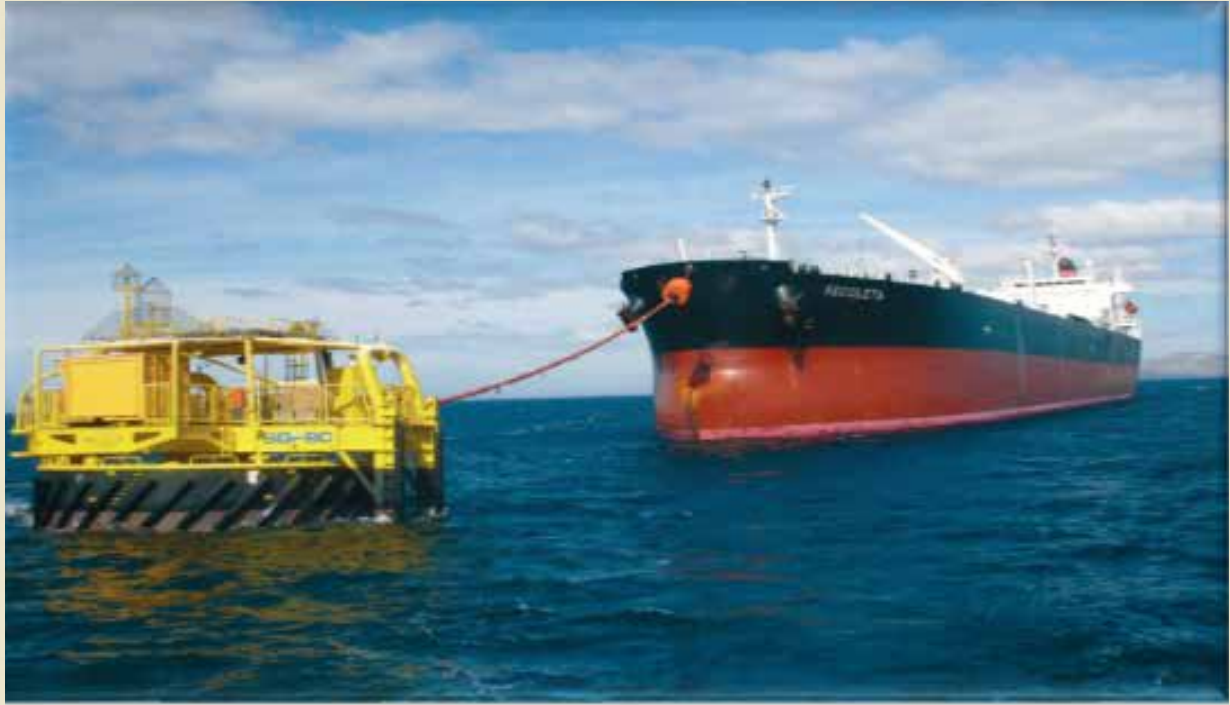
চিত্র: ইনস্টলেশন অব সিস্টেম পয়েন্ট মুরিং (এসপিএম) উইথ ডাবল পাইপ লাইন, ইস্টার্ন রিফাইনারি লিমিটেড
