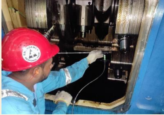
চিত্রঃ Crankshaft hot deflection measure করা হচ্ছে
