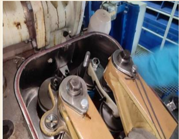
চিত্রঃ Yoke and valve clearance চেক করা হচ্ছে
