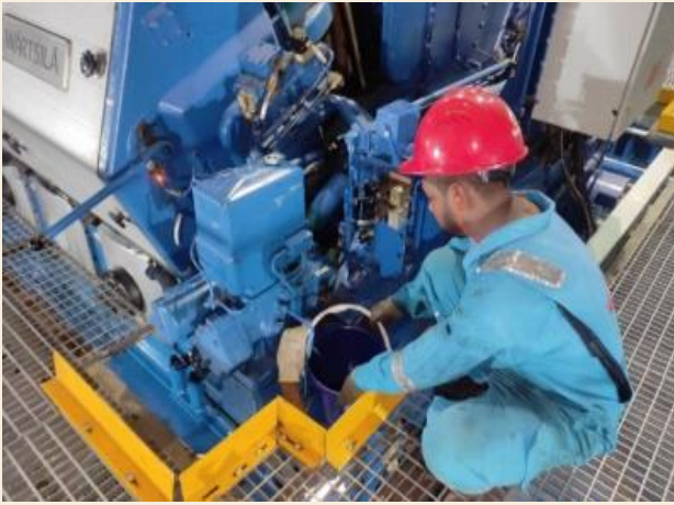
চিত্রঃ Actuator এর used oil বের করে নতুন oil দেওয়া হচ্ছে
