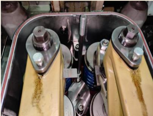
চিত্রঃ Yoke and valve clearance চেক করা হচ্ছে
