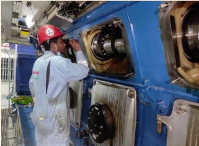
চিত্রঃ Camshaft contact faces inspection করা হচ্ছে
