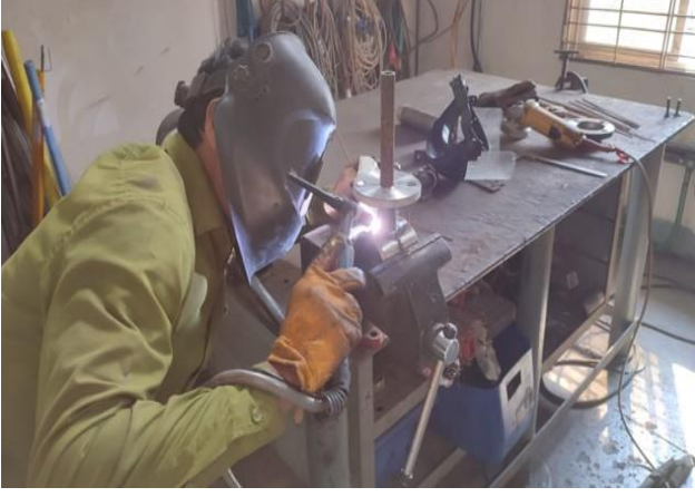
চিত্র-৩.১ : এসিড ডোজিং সিস্টেমের Ejector Fabrication work. চিত্র-৩.২ : GT Lube Oil System এর Vapor Extractor Fan-B এর মেরামত কার্যক্রম।
