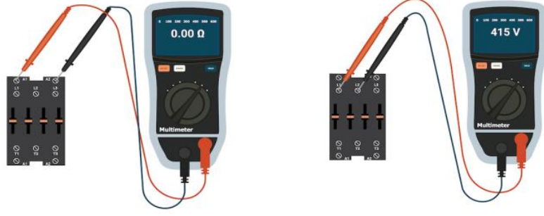
(৩) খারাপ কয়েল ০.০০ওহম (১০-১০০ ওহম হলে ভাল) (৪) লাইন ভোল্টেজ (সাপ্লাই চালু)
