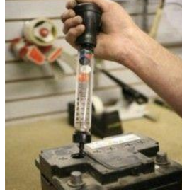
চিত্রঃ হাইড্রোমিটার ব্যবহার করে ব্যাটারির ইলেক্ট্রোলাইটের আপেক্ষিক গুরুত্ব পরিমাপ করা হচ্ছে।
