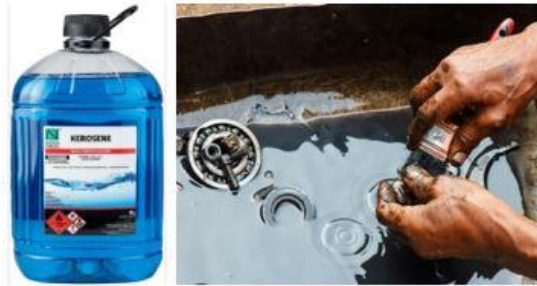
চিত্রঃ কেরোসিন (Kerosene) ব্যবহার করে পার্টস/ টুলস পরিষ্কার
