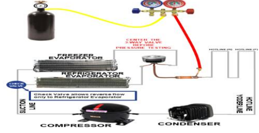
চিত্র : রেফ্রিজারেশন সাইকেলের প্রেসার টেস্ট
