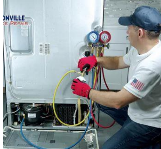
চিত্র : রেফ্রিজারেশন সাইকেলের লিক টেস্ট
