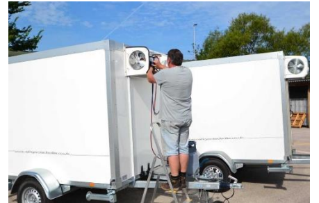
চিত্র: ইউনিটটি চালু করে প্রকৃত সমস্যা নিশ্চিত করা
