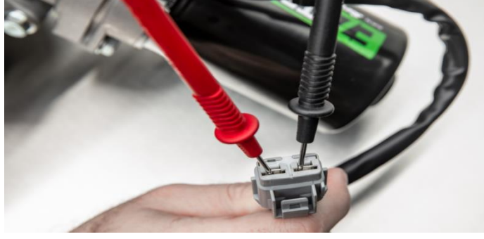
চিত্রঃ ইলেক্ট্রনিক পাওয়ার স্টিয়ারিং এর ওয়্যারিং চেক করা হচ্ছে।
