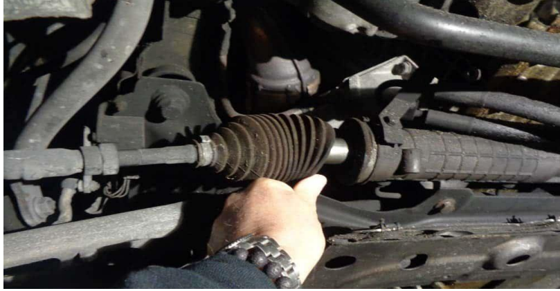
চিত্র: স্টিয়ারিং সিস্টেমের ত্রুটিপূর্ণ রেক বুট পরিবর্তন করা হচ্ছে।
