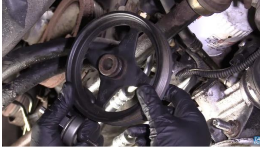
চিত্রঃ পাওয়ার স্টিয়ারিং পাম্প চেক করা হচ্ছে।
