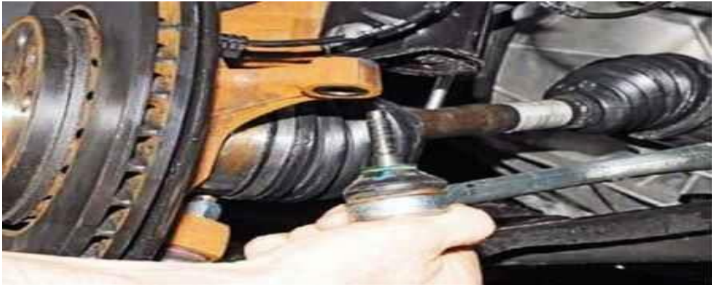
চিত্র: স্টিয়ারিং সিস্টেমের ত্রুটিপূর্ণ কম্পোনেন্ট পরিবর্তন করা হচ্ছে।
