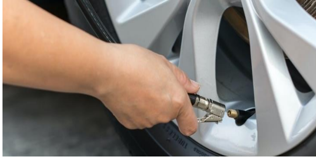
চিত্রঃ টায়ার ভালভ স্টেমের সাথে এয়ার পাম্পের অগ্রভাগ বা ইনফ্লেটোর চক সংযুক্ত করা হচ্ছে।
