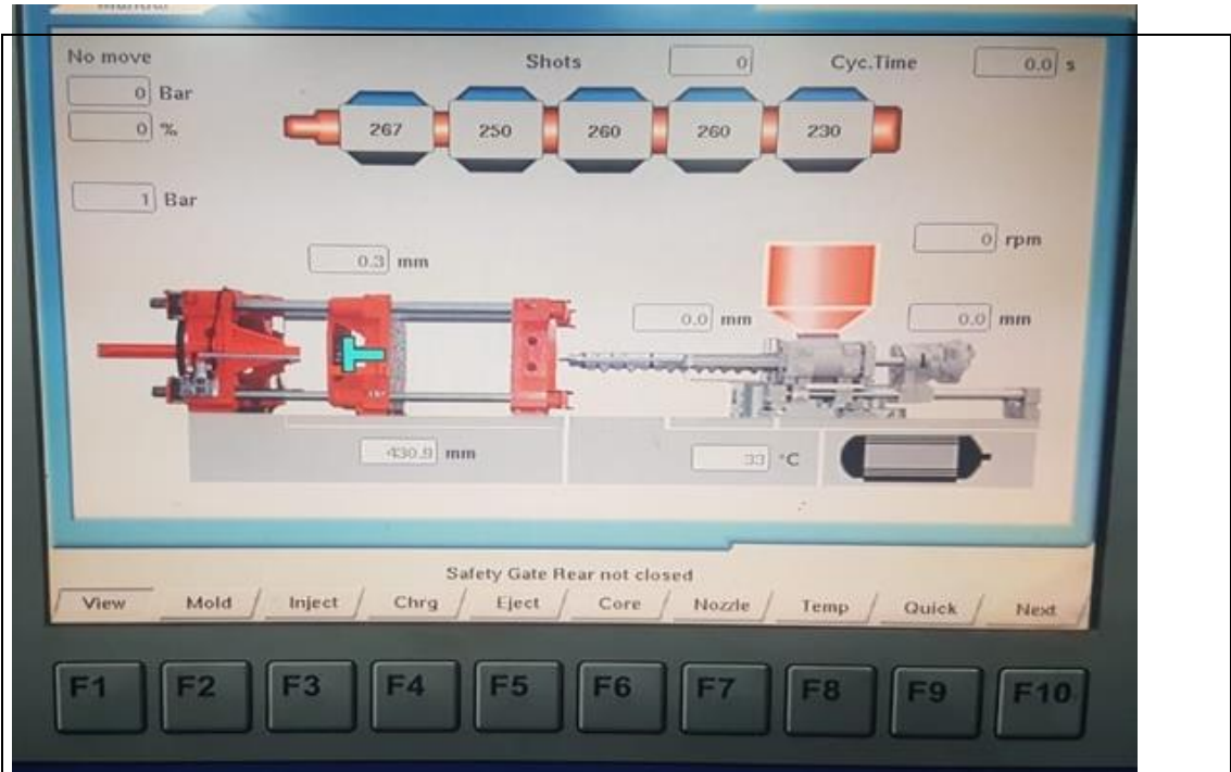
এইচএমআই (HMI) ওভার ভিউ (Over view) স্ক্রিন
