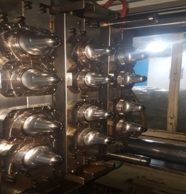
১২ কাভিটি প্রিফর্ম মোল্ড কোর পার্ট (Preform Mold Core Part)
