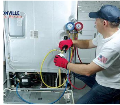
চিত্র : রেফ্রিজারেশন সাইকেলের লিক টেস্ট
