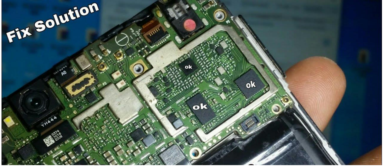
চিত্র: Searching/no service/emergency সমস্যা মেরামত করার কৌশল
