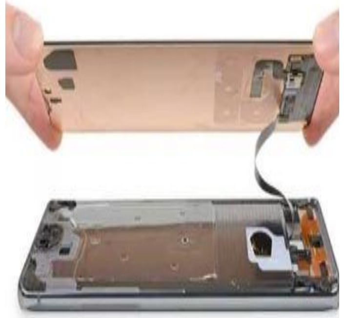
চিত্র: Touch/glass broken সমস্যা মেরামত পদ্ধতি
