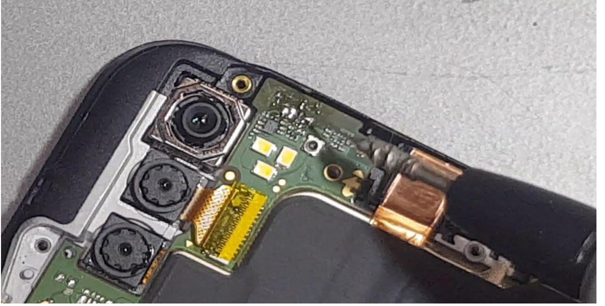
চিত্র: Weak network signal সমস্যা মেরামত করার কৌশল
