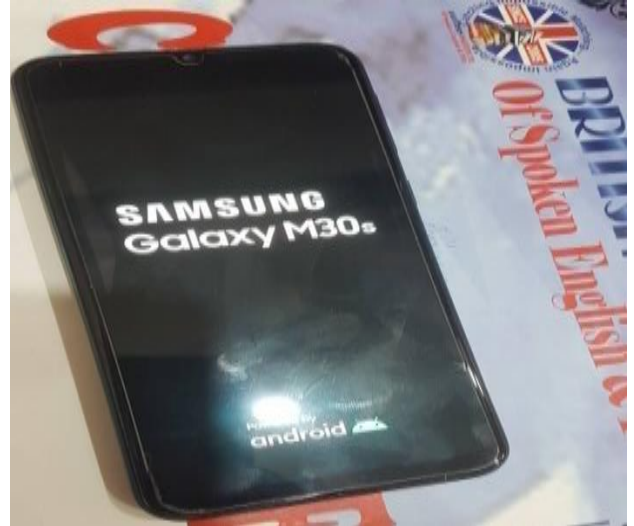
চিত্র: Stuck on Logo সমস্যার লক্ষণ
