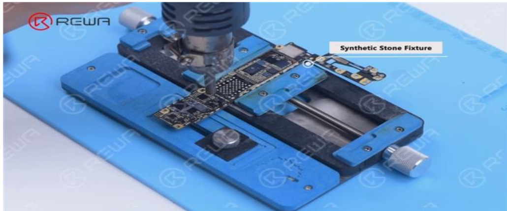
চিত্র : Inductor রিপ্লেস
