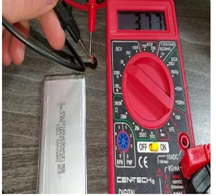
চিত্র : Connector পরীক্ষা
