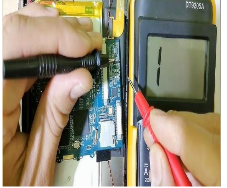
চিত্র : Fuse পরীক্ষা
