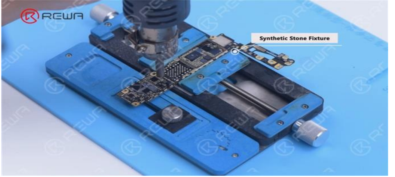
চিত্র : Fuse রিপ্লেস
