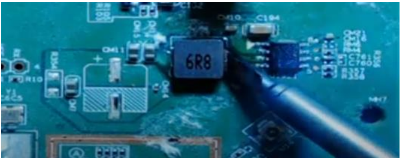
চিত্র : Inductor রিপ্লেস
