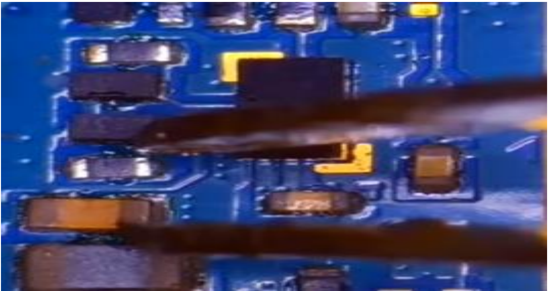
চিত্র : Capacitor রিপ্লেস
