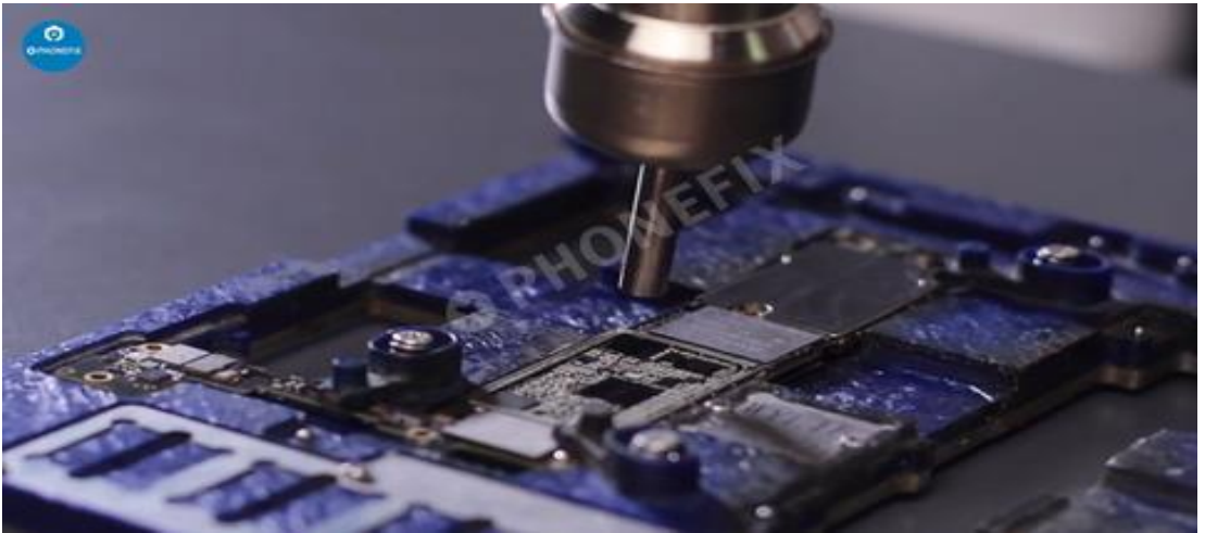
চিত্র : IC রিপ্লেস
