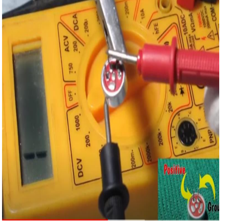
চিত্র : Microphone পরীক্ষা
