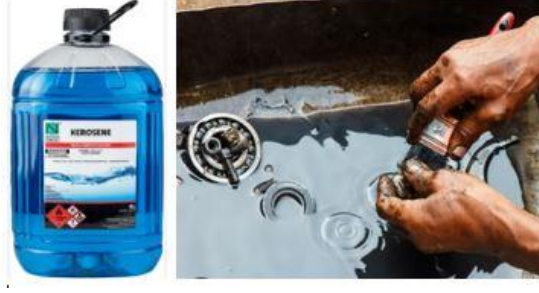
চিত্রঃ কেরোসিন (Kerosene) ব্যবহার করে পার্টস/ টুলস পরিষ্কার
