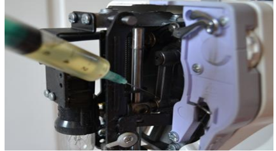
কোণে ধুলো জমে থাকা অপসারণের জন্য একটি সুচের ভেঁতা প্রাপ্ত ব্যবহার করে।
