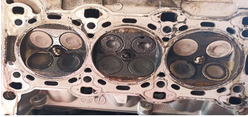
চিত্রঃ সিলিন্ডার গেড বা কভার খুলে ভালভ সমূহ উন্মুক্ত করা হয়েছে।
