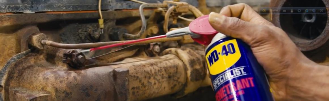
চিত্রঃ বোল্টের মাথায় পেনিট্রেটিং ওয়েল স্প্রে করা হচ্ছে।
