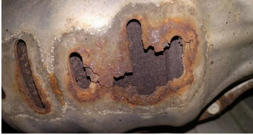
চিত্রঃ মরিচা দ্বারা আক্রান্ত হয় নষ্ট হয়ে যাওয়া ক্যাটালিটিক কনভার্টার।
