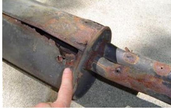
চিত্রঃ মরিচা ধরে মাফলারটি একদম নষ্ট হয়ে গিয়েছে।
