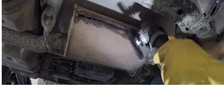
চিত্রঃ মাফলারের ফাটলের চারপাশ মেরামতের জন্য পরিষ্কার করা হচ্ছে।
