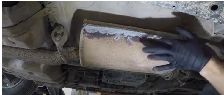
চিত্রঃ উচ্চ-তাপমাত্রার ব্যবহার উপযোগী ছিদ্র মেরামতের কিট ব্যবহার মেরামত করা হচ্ছে।
