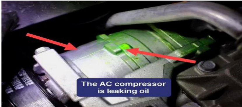
চিত্র: ট্রান্সপোর্ট রেফ্রিজারেশন কম্প্রেসার ওয়েল লিক
