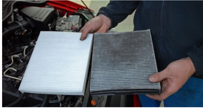
চিত্রঃ পুরাতন এয়ার ফিল্টার পরিবর্তন করে নতুন এয়ার ফিল্টার প্রতিস্থাপন করা হচ্ছে।
