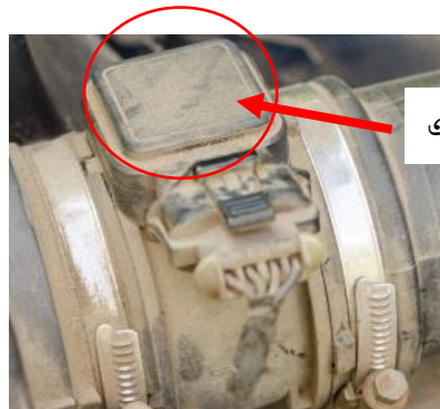
চিত্র: ময়লা এয়ার ফ্লো সেন্সর।
