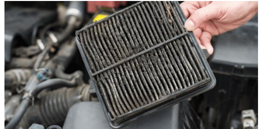
চিত্রঃ ক্লগড এয়ার ফিল্টার।
