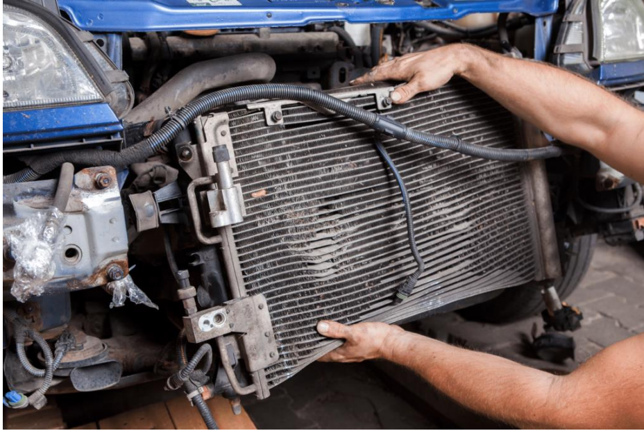
চিত্রঃ ইন্টারকুলার পরীক্ষা করা হচ্ছে।
