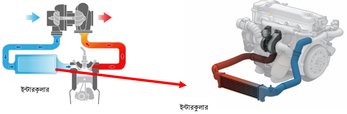
চিত্র: ইন্টারকুলারের কার্যপ্রণালী।
