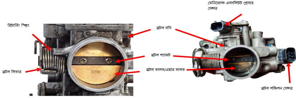
চিত্র: কনভেনশনাল থ্রটল বডিতে থ্রটল ভালভ ও অন্যান্য যন্ত্রাংশ।
