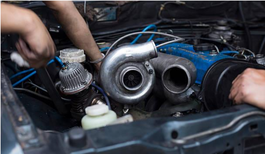
চিত্রঃ টার্বোচার্জার ও সুপার চার্জার সিস্টেম পরীক্ষা করা হচ্ছে।
