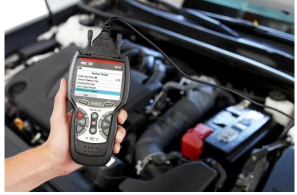
চিত্রঃ ওবিডি-২ স্ক্যানার ব্যবহার করে এয়ার ইন্ডাকশন সিস্টেমের ত্রুটি নির্ণয় করা হচ্ছে।
