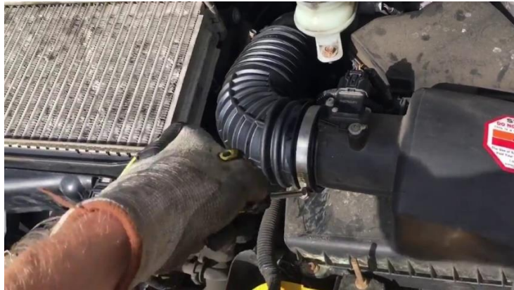
চিত্রঃ এয়ার ইনটেক সিস্টেমের হোস টিউব মেরামত করা হচ্ছে।
