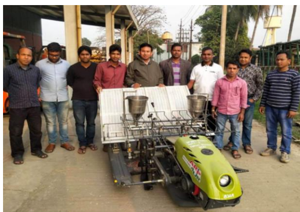
Fig. 27. Rice transplanter cum fertilizer applicator (Walking type)
