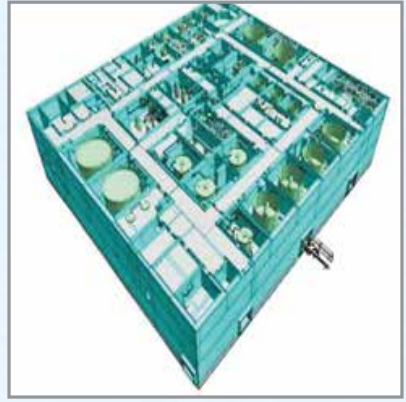
অক্সিলিয়ারি বিল্ডিং এবং এর +৪.৭৫ মিটার উচ্চতার স্থাপিত যন্ত্রাংশের চিত্র
