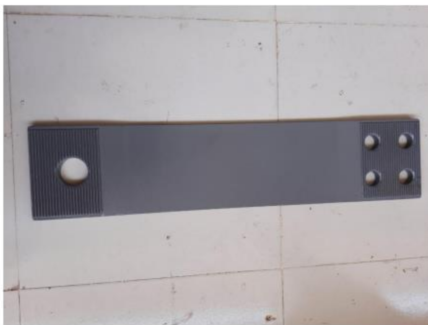
চিত্র ৭: বর্তমানে উদ্ভাবিত ও ব্যবহৃত অরিজিনালের অনুরূপ গুণসম্পন্ন হুইলসেট গাইড
