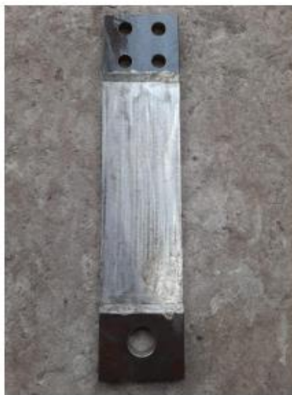
চিত্র ৬: পরবর্তীতে স্থানীয় সাপ্লায়ারের নিকট থেকে সংগৃহীত হুইলসেট গাইড
