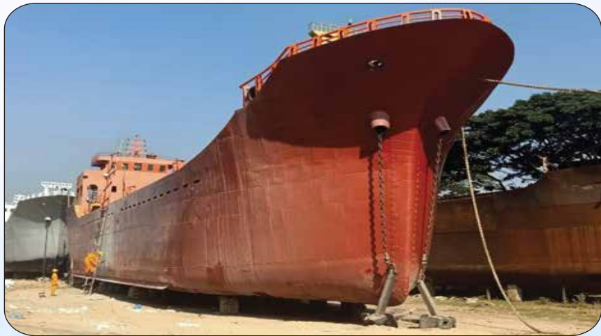
চিত্র: মাল্টিচ্যানেল স্লিপওয়ে ডকইয়ার্ডে মেরামতের জন্য ডকিংকৃত ট্রলার
