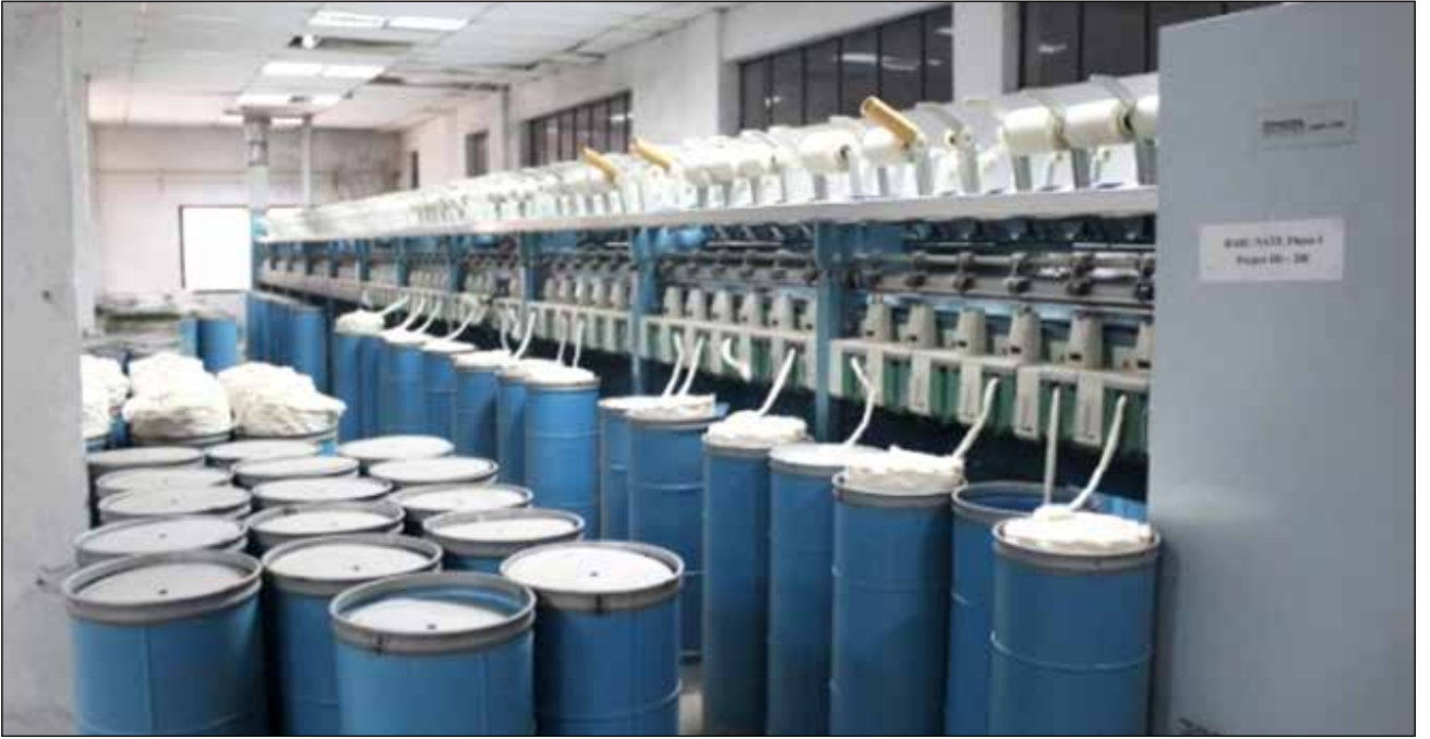
বিজেআরআই কর্তৃক উদ্ভাবিত পাট, তুলা ও আনারসের ফাইবার মিশ্রিত সুতা উৎপাদন (৩০:৫০:২০) প্রক্রিয়া।
