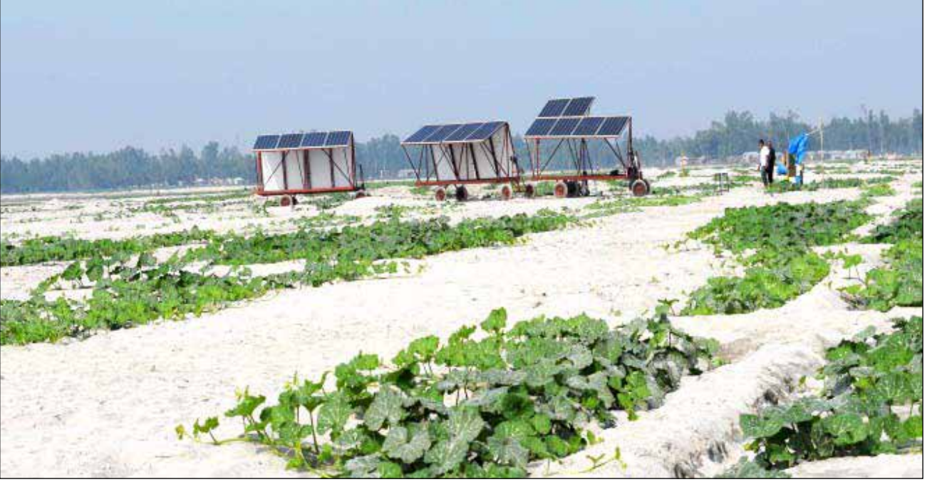
রংপুর অঞ্চলে ভূপরিষ্ক পানি সংরক্ষণের মাধ্যমে ক্ষুদ্রসেচ উন্নয়ন ও সেচ দক্ষতা বৃদ্ধিকরণ প্রকল্পের আওতায় নির্মিত প্রামাণ্য ট্রলিতে সোলারচালিত এলএলপির মাধ্যমে সেচ প্রদান।
