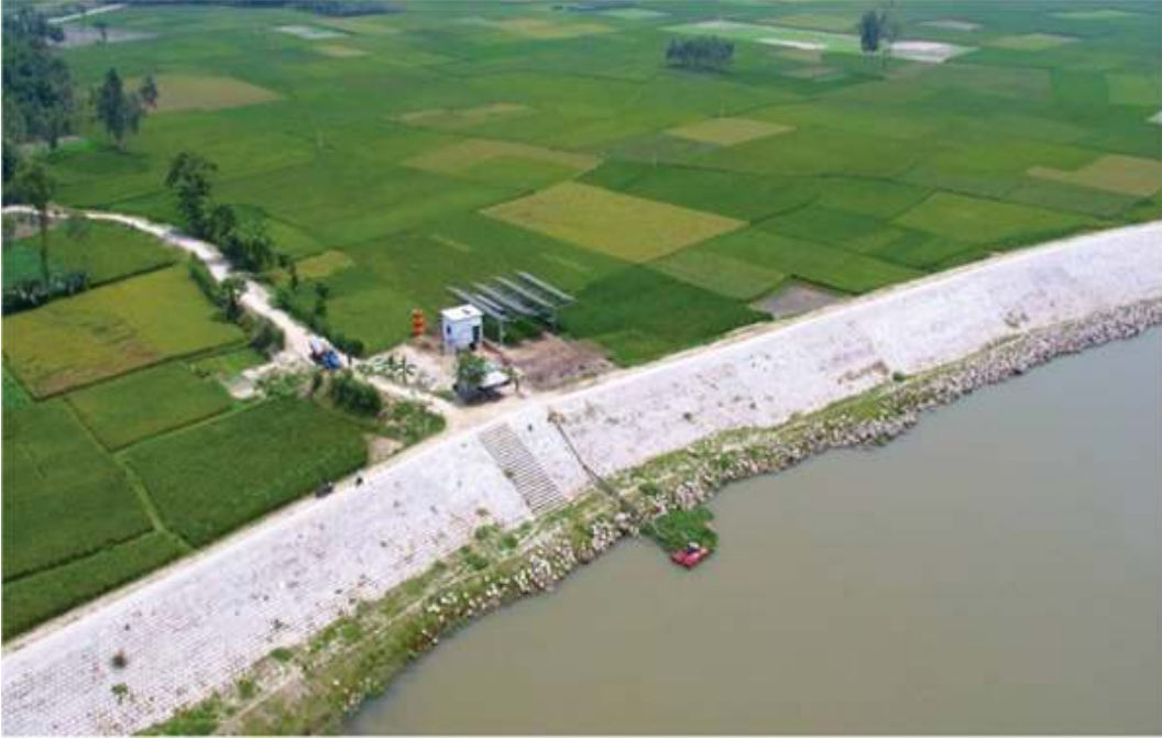
রংপুর জেলার পীরগাছা উপজেলার খননকৃত খালপাড়ে স্থাপিত সৌরচালিত এলএলপি
