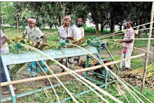
ব্রি-বিজেআরআই উদ্ভাবিত শক্তিচালিত জুট রিপনার
