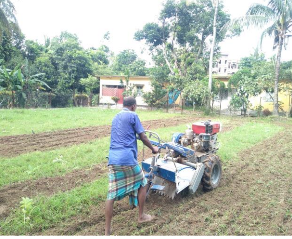
সংযুক্তি (৯-ক): পাওয়ার টিলার দ্বারা গবেষণা মাঠে চাষ প্রদান করে জমি তৈরি
