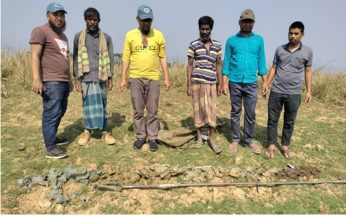
চিত্র-৩: অগার কূপ খননের মাধ্যমে ভূগর্ভস্থ পললের নমুনা সংগ্রহ ও পরীক্ষণ, নিজপাট ইউনিয়ন।
