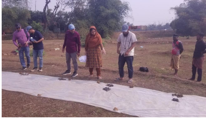
চিত্র-৭: দেশীয় টিউবওয়েল খনন পদ্ধতিতে (চপিং) এর মাধ্যমে ভূগর্ভস্থ পললের নমুনা সংগ্রহ ও পরীক্ষণ, জৈন্তাপুর ইউনিয়ন।
