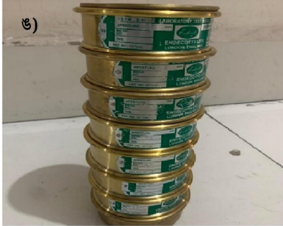
চিত্র -সিলেট ও সুনামগঞ্জ জেলার পাথর কোয়ারির কার্যপদ্ধতি ক) চপিং পদ্ধতিতে বোর হোল খনন, খ) অগার পদ্ধতিতে কূপ খনন, গ) রেজিস্টিভিটি (Resistivity) জরিপ/তড়িৎ প্রতিবদ্ধকতা পদ্ধতি ঘ) পিট খনন ঙ) হ্যান্ড সিভ (Hand Sieve) চ) হ্যান্ড সিভ (Hand Sieve) বিশ্লেষণ।
