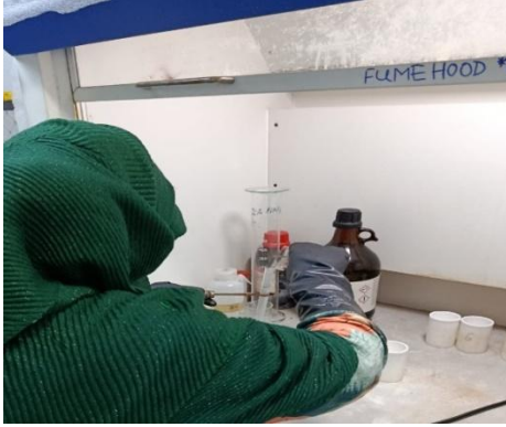
প্লট-০৫: এলিমেন্ট এনালাইসিস এর জন্য ICP-MS ল্যাবরেটরিতে নমুনার ডাইজেশন সম্পাদন।
