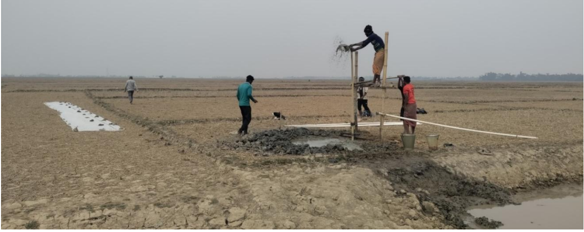
চিত্র-৫: দেশীয় টিউবওয়েল খনন পদ্ধতিতে (চপিং) ভূগর্ভস্থ পলল নমুনা পরীক্ষণ, পর্যবেক্ষণ, নমুনা সংগ্রহ, দরবস্ত ইউনিয়ন।
