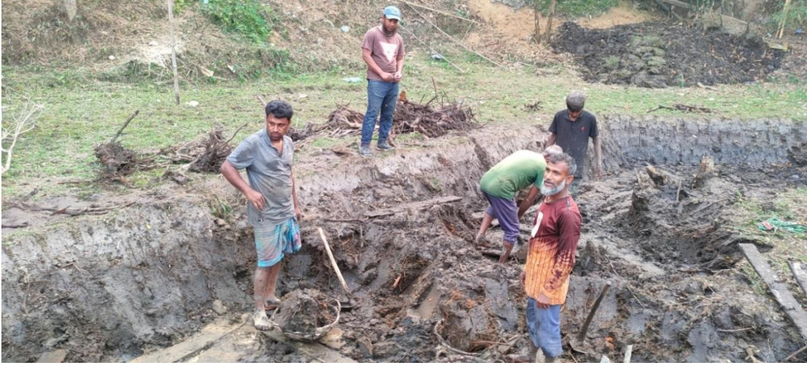
চিত্র-৪: পিট খননের মাধ্যমে ভূগর্ভস্থ পললের নমুনা সংগ্রহ ও পরীক্ষণ, নিজপাট ইউনিয়ন।
