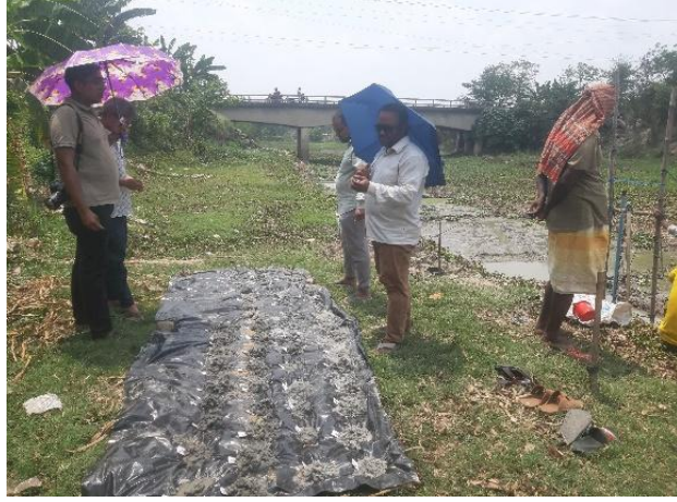
চিত্রঃ মঙ্গলকোট, কেশবপুর উপজেলা, যশোর-এ ওয়াশ বোরিং মাটির নমুনা পরীক্ষণ।
