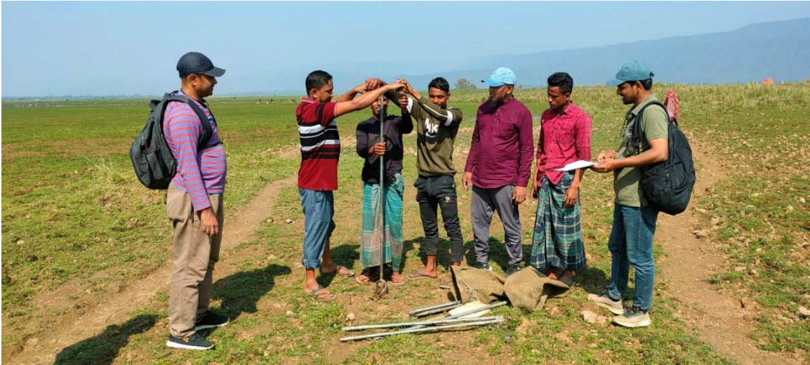
চিত্র-২: অগার কূপ খননের মাধ্যমে ভূগর্ভস্থ পললের নমুনা সংগ্রহ ও পরীক্ষণ, জৈন্তাপুর ইউনিয়ন।
