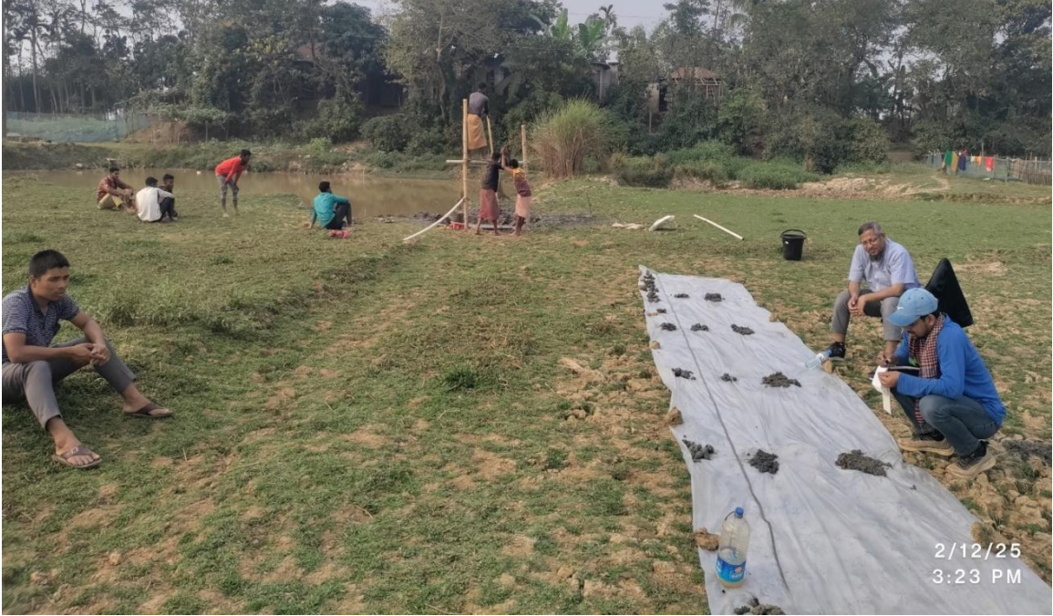
চিত্র-৬: দেশীয় টিউবওয়েল খনন পদ্ধতিতে (চপিং) এর মাধ্যমে ভূগর্ভস্থ পললের নমুনা সংগ্রহ ও পরীক্ষণ, নিজপাট ইউনিয়ন।
