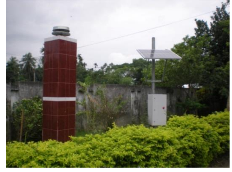
জিপিএসঃ একটি ডি টেকটনিক্স, ভূমিকম্প, প্লেট মুভমেন্ট গবেষণার কাজে ব্যবহৃত জিওডেটিক তথ্য-উপাত্ত সংগ্রহের জন্য স্থায়ী জিপিএস স্টেশন
