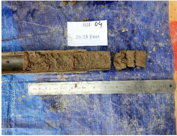
চিত্র: কূপ খননের মাধ্যমে সংগৃহীত ভূ-অভ্যন্তরস্থ পলল।
