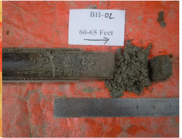
চিত্র: কূপ খননের মাধ্যমে সংগৃহীত ভূ-অভ্যন্তরস্থ পলল।
