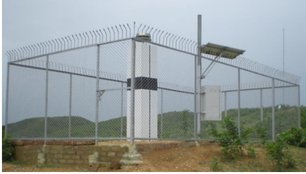
জিপিএসঃ একটি ডি টেকটনিক্স, ভূমিকম্প, প্লেট মুভমেন্ট গবেষণার কাজে ব্যবহৃত জিওডেটিক তথ্য-উপাত্ত সংগ্রহের জন্য স্থায়ী জিপিএস স্টেশন
