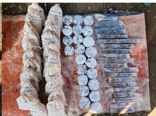
চিত্র ৯: ভূপ্রকৌশল কুপ খনন কার্যক্রম ও লগ প্রস্তুতকরণ
