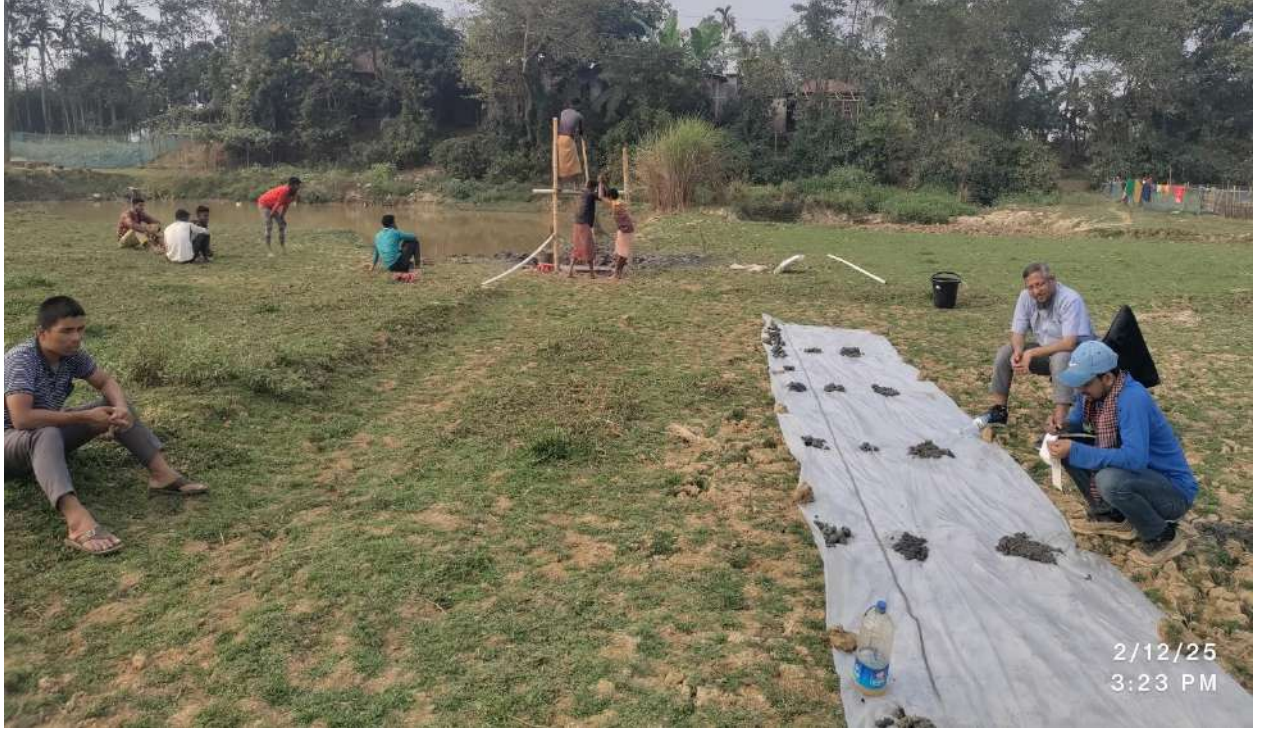
চিত্রঃ দেশীয় টিউবওয়েল খনন পদ্ধতিতে (চপিং) এর মাধ্যমে ভূগর্ভস্থ পললের নমুনা সংগ্রহ ও পরীক্ষণ, নিজপাট ইউনিয়ন।
