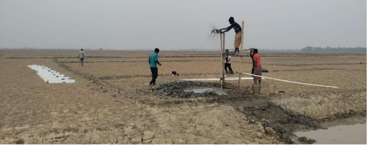
চিত্রঃ দেশীয় টিউবওয়েল খনন পদ্ধতিতে (চপিং) এর মাধ্যমে ভূগর্ভস্থ পললের নমুনা সংগ্রহ ও পরীক্ষণ, দরবস্ত ইউনিয়ন।
