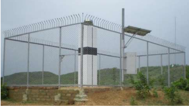
জিপিএসঃ একটিভ টেকটনিয়, ভূমিকম্প, প্লে ট মুভমেন্ট গবেষণার কাজে ব্যবহৃত জিওডেটিক তথ্য-উপাত্ত সংগ্রহের জন্য স্থায়ী জিপিএস স্টেশন
