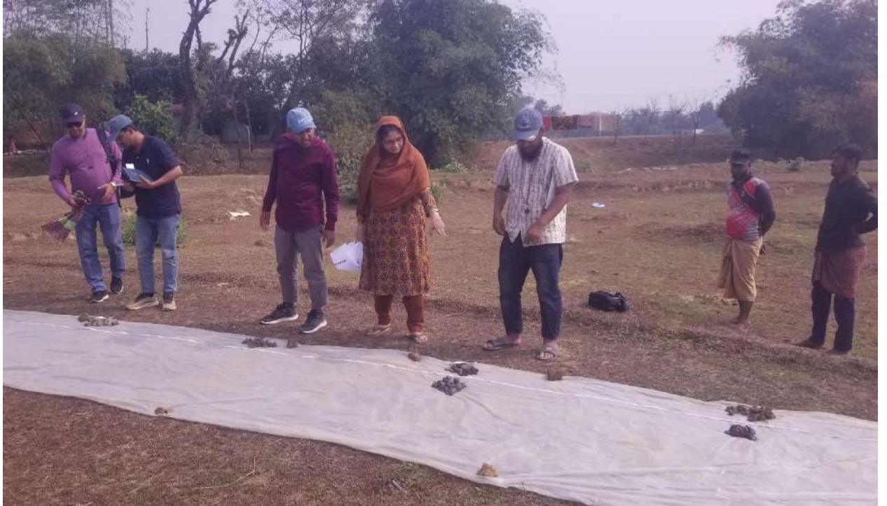
চিত্রঃ দেশীয় টিউবওয়েল খনন পদ্ধতিতে (চপিং) এর মাধ্যমে ভূগর্ভস্থ পললের নমুনা সংগ্রহ ও পরীক্ষণ, জৈন্তাপুর ইউনিয়ন।
