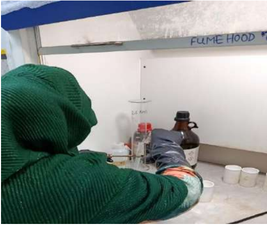
প্লেট-০৫: এলিমেন্ট এনালিসিস এর জন্য ICP-MS ল্যাবরেটরিতে নমুনার ডাইজেশন সম্পাদন।
