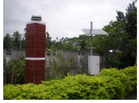
জিপিএসঃ একটিভ টেকটনিয়, ভূমিকম্প, প্লে ট মুভমেন্ট গবেষণার কাজে ব্যবহৃত জিওডেটিক তথ্য-উপাত্ত সংগ্রহের জন্য স্থায়ী জিপিএস স্টেশন
