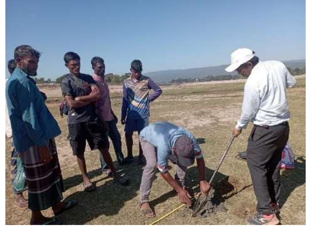
প্লেট-০২: ডাউকি নদীর চরে পললের নমুনা সংগ্রহ এবং বিভিন্ন স্তর পর্যবেক্ষণের জন্য অগার কুপ খনন।
