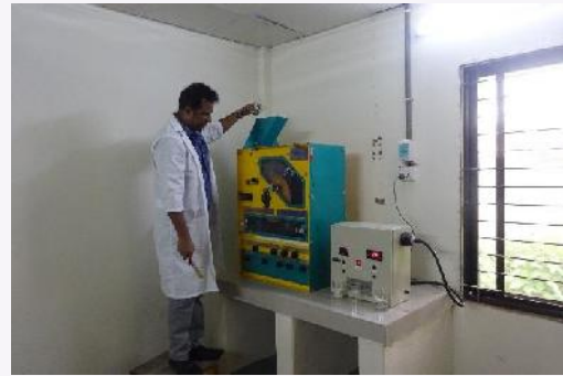
ইলেকট্রোস্ট্যাটিক প্লেট সেপারেটরঃ নমুনার চৌম্বকীয় এবং নন-চৌম্বকীয় ভগ্নাংশগুলি পরিবাহী এবং অপরিবাহী খনিজগুলির ভগ্নাংশ থেকে পৃথক করতে ইলেক্ট্রোস্ট্যাটিক প্লেট ব্যবহৃত হয়।
