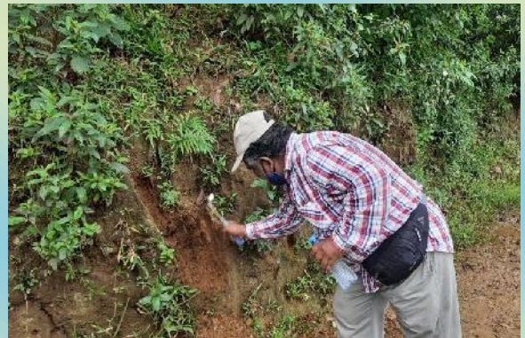
চিত্র-১: পাহাড়ি এলাকার ঢাল, অভিমুখ পরিমাপ ও শিলার ভৌত অবস্থা পর্যবেক্ষণ।
