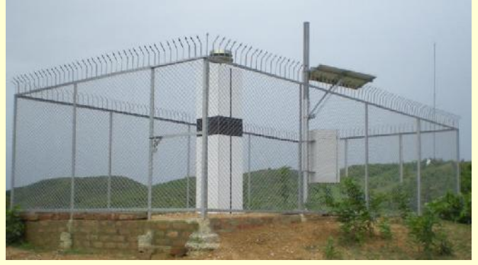
জিপিএসঃ একটিভ টেকটনিক্স, ভূমিকম্প, প্লেট মুভমেন্ট গবেষণার কাজে ব্যবহৃত জিওডেটিক তথ্য-উপাত্ত সংগ্রহের জন্য স্থায়ী জিপিএস স্টেশন।
