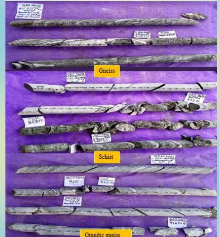
চিত্র ৩: খননকৃত কুপ থেকে সংগৃহীত বিভিন্ন ধরনের আদি শিলার নমুনা।
