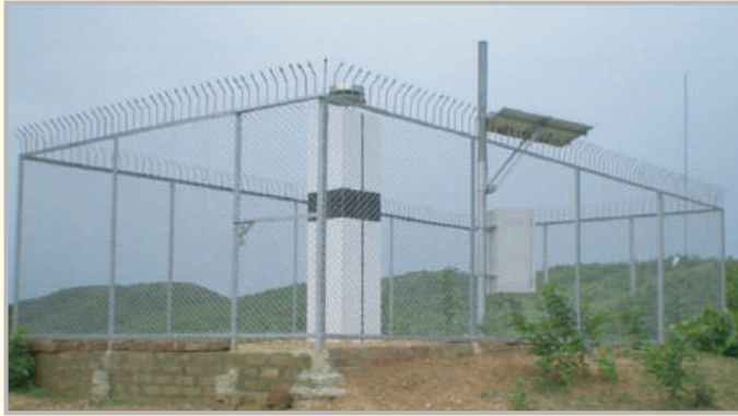
জিপিএস : একটিভ টেকটনিক্স, ভূমিকম্প, প্লেট মুভমেন্ট গবেষণার কাজে ব্যবহৃত জিওডেটিক তথ্য-উপাত্ত সংগ্রহের জন্য স্থায়ী জিপিএস স্টেশন
