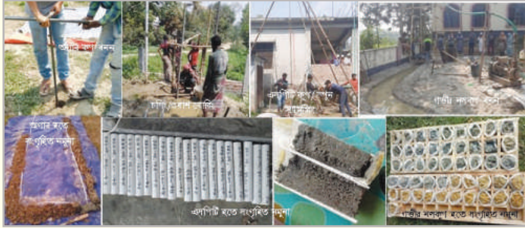
চিত্র-২. অগার কূপ, চপাং/ওয়াশ বোরিং, এসপিটি কূপ/স্পুন স্যাম্পিং ও গভীর নলকূপ খনন এবং এসব কূপ খননের মাধ্যমে প্রাপ্ত নমুনা
