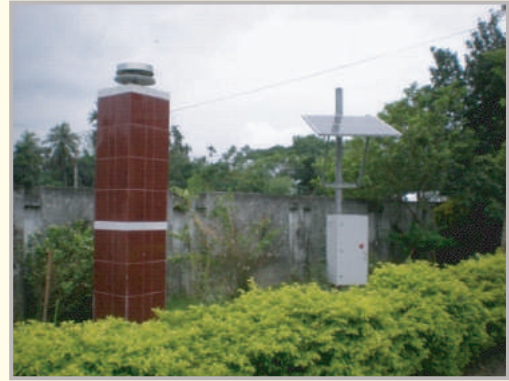
জিপিএস : একটিভ টেকটনিক্স, ভূমিকম্প, প্লেট মুভমেন্ট গবেষণার কাজে ব্যবহৃত জিওডেটিক তথ্য-উপাত্ত সংগ্রহের জন্য স্থায়ী জিপিএস স্টেশন
