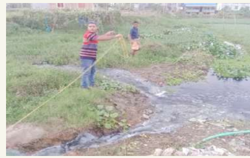
চিত্র : তথ্য সংগ্রহের জন্য Resistivity লাইন প্রকৃতি।
