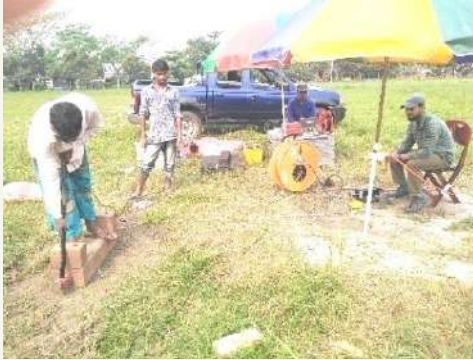
চিত্র : PS লগিং বা ডাউনহোল সিসমিক শেয়ার ওয়েভ ভেলোসিটি জরিপ কার্যক্রম
