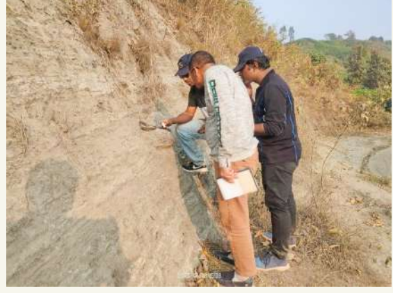
চিত্র : লেবুবাজার-জৈষ্ঠাপুরা সেকশন বরাবর উন্মুক্ত শিলাস্তরের নতি পরিমাপ, বৈশিষ্ট্যন ও নমুনা সংগ্রহ।
