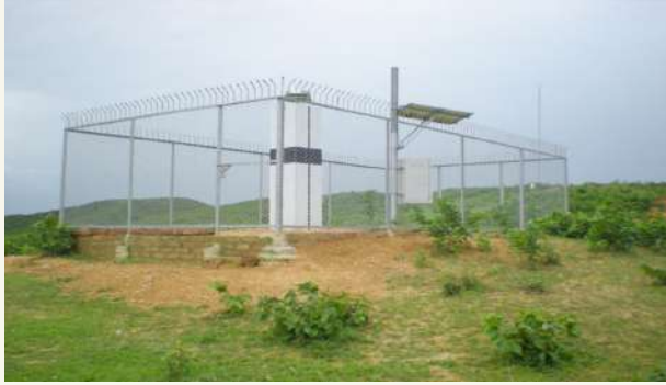
জিপিএস : একটি ডেকটনিব্র, ভূমিকম্প, প্লেট মুভমেন্ট গবেষণার কাজে ব্যবহৃত জিওডেটিক তথ্য-উপাত্ত সংগ্রহের জন্য স্থায়ী জিপিএস স্টেশন
