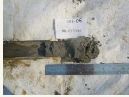
চিত্র : কূপ খননের মাধ্যমে সংগৃহীত ভূ-অভ্যন্তরস্থ পলল।
