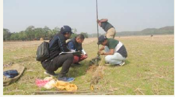
চিত্র: অগার কূপ খননের মাধ্যমে ভূগর্ভস্থ পলল এর বৈশিষ্ট্যন, ভূমিরূপের শ্রেণিবিন্যাসকরণ ও নমুনা সংগ্রহ।
