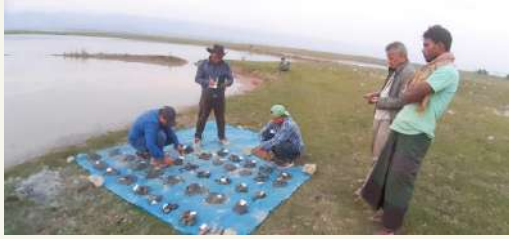
চিত্র : বিশ্বম্ভরপুর উপজেলায় কানলার হাওড়ের প্রান্তে সম্পাদিত চপিং পদ্ধতিতে ভূগর্ভস্থ মাটির নমুনা মাঠ পর্যায়ে পরীক্ষণ
