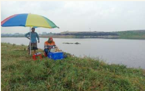
চিত্র : Resistivity তথ্য সংগ্রহ
