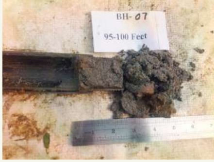
চিত্র : কূপ খননের মাধ্যমে সংগৃহীত ভূ-অভ্যন্তরস্থ পলল।
