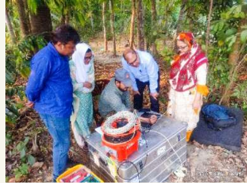
চিত্র : PS লগিং বা ডাউনহোল সিসমিক শেয়ার ওয়েভ ভেলোসিটি জরিপ পরিদর্শন
