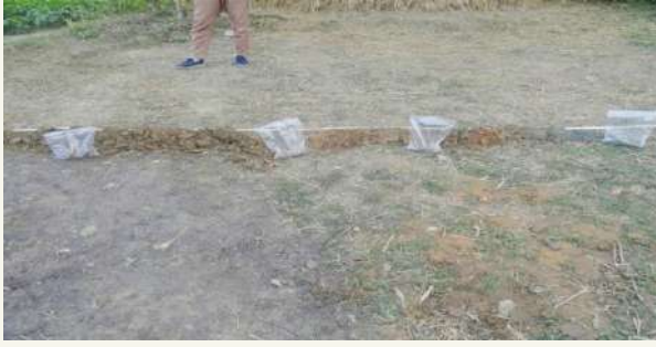
চিত্র: অগার কূপ খননের মাধ্যমে ভূগর্ভস্থ পলল এর বৈশিষ্ট্যন, ভূমিরূপের শ্রেণিবিন্যাসকরণ ও নমুনা সংগ্রহ।
