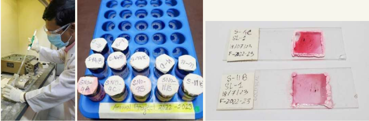
চিত্র : পরীক্ষাগারে নমুনা প্রস্তুতকরণ; প্রক্রিয়াজাত নমুনা; মাইক্রোস্কোপে পর্যবেক্ষণের উদ্দেশ্যে প্রস্তুতকৃত প্যালিনোলজিক্যাল স্লাইড
