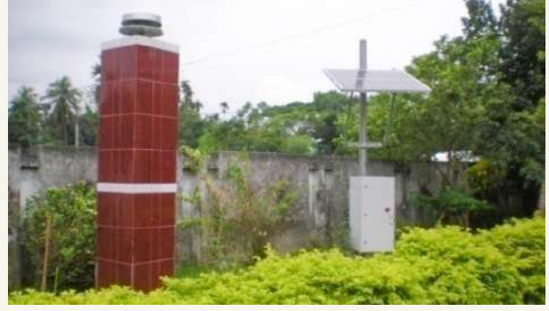
জিপিএস : একটি ডেকটনিব্র, ভূমিকম্প, প্লেট মুভমেন্ট গবেষণার কাজে ব্যবহৃত জিওডেটিক তথ্য-উপাত্ত সংগ্রহের জন্য স্থায়ী জিপিএস স্টেশন
