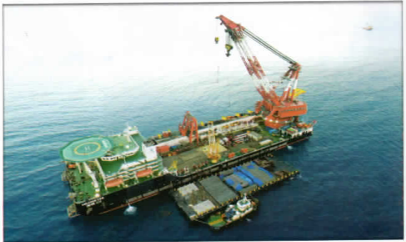
এসপিএম প্রকল্পের অফশোর পাইপ লাইন স্থাপনে ব্যবহৃত বিশেষ বার্জ Hilong 106 এর চিত্র
