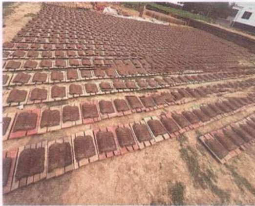
চিত্র-৯ : আকার তৈরী হওয়ার পর রোদে শুকানো হচ্ছে।
