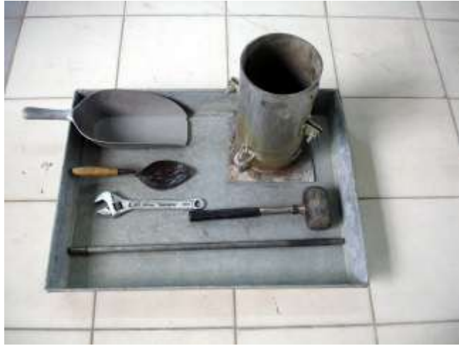
চিত্র - ৬.৩.১ : সিলিন্ডার তৈরির যন্ত্রপাতি ও উপকরণ
