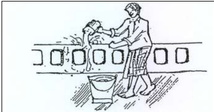
চিত্র- ৫.৩ : খাড়া দেওয়ালে পিচকারি বা ছোট পাত্র দ্বারা পানি ছিটিয়ে দেওয়ার ব্যবস্থা
