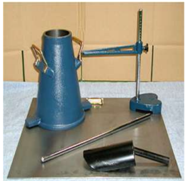
চিত্র -৬.২.১ : স্ল্যাম্প টেস্টের যন্ত্রপাতি
