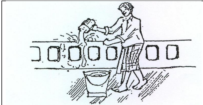
চিত্র- ৫.১৬ : খাড়া দেওয়ালে পিচকারী বা ছোট পাত্র দ্বারা পানি ছিটিয়ে দেয়ার ব্যবস্থা
