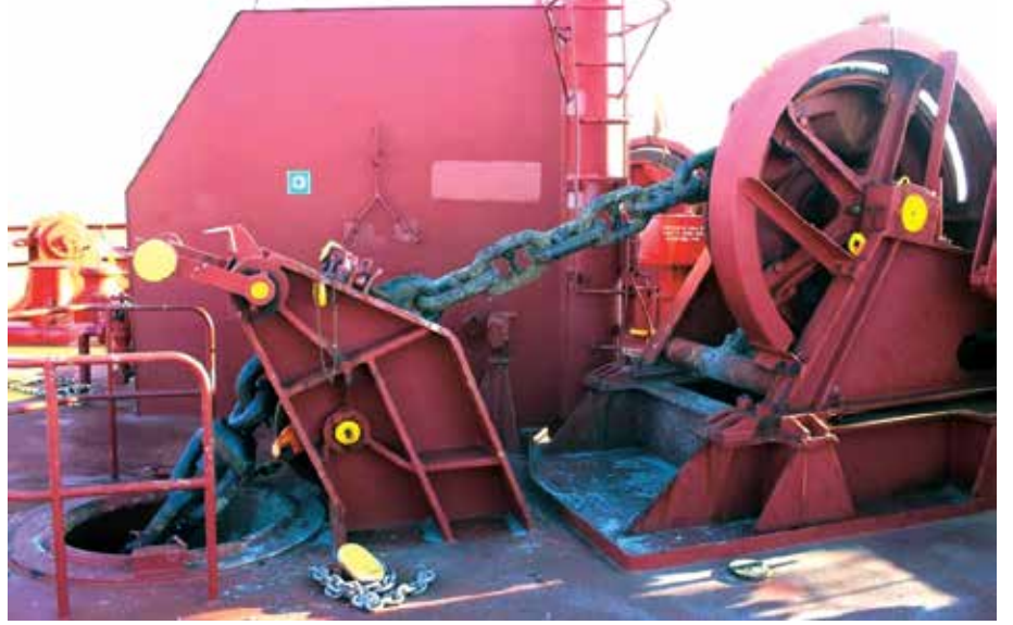
শিকল ও নোঙরের আকার, ওজন, ধরন এবং নোঙরের কাজে ব্যবহৃত যন্ত্রপাতির অবস্থার কারণে নোঙর-দুর্ঘটনা ঘটতে পারে
