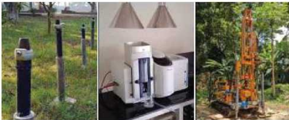
ছবি ১: (বাম দিক হতে) বাংলাদেশের বিভিন্ন স্থানে ৯০৫টি অটোমেটেডকৃত পর্যবেক্ষণকূপের ১টি ওচ্ছকূপ; পানির গুণাগুণ পরিমাপের জন্য ল্যাবরেটরীতে স্থাপিত এটমিক এবসরপশন স্পেকট্রোস্কোপিমিটার; বিভিন্ন অবকাঠামোর নকশা থনয়ণের লক্ষ্যে ভূ-কারিগরী অনুসন্ধানের জন্য সংগৃহীত ড্রিলিং রিগ।
