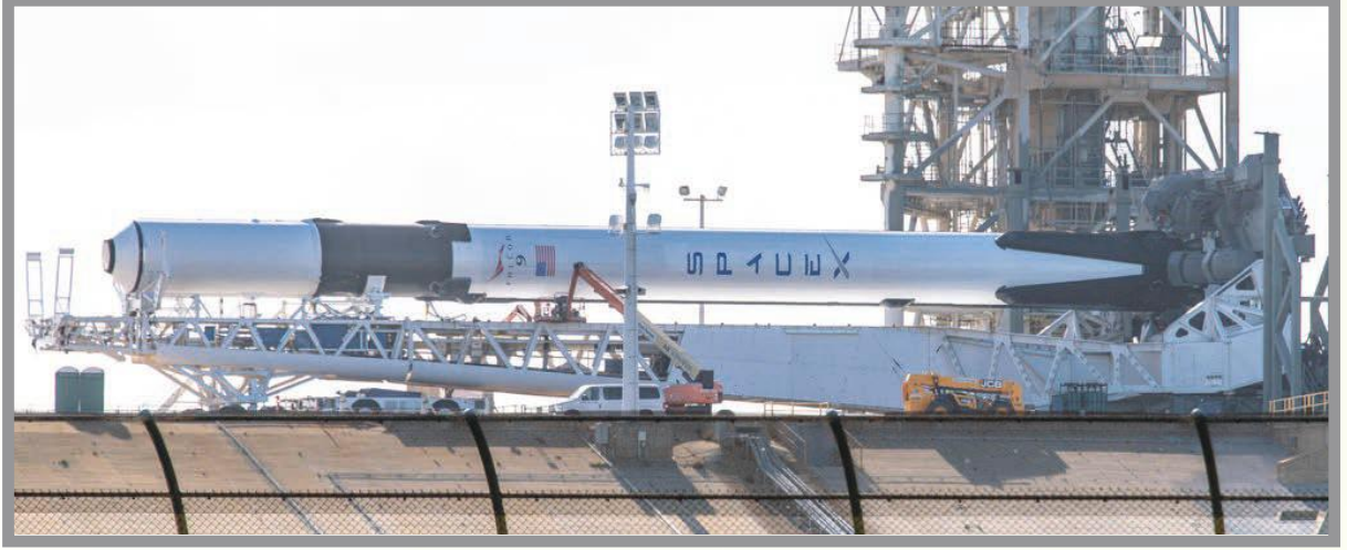
Falcon 9 লঞ্চ ভেহিকেল এর ইন্টিগ্রেশন শেষে টেস্টিং এর জন্য লঞ্চ প্যাডে প্রেরণকালে
