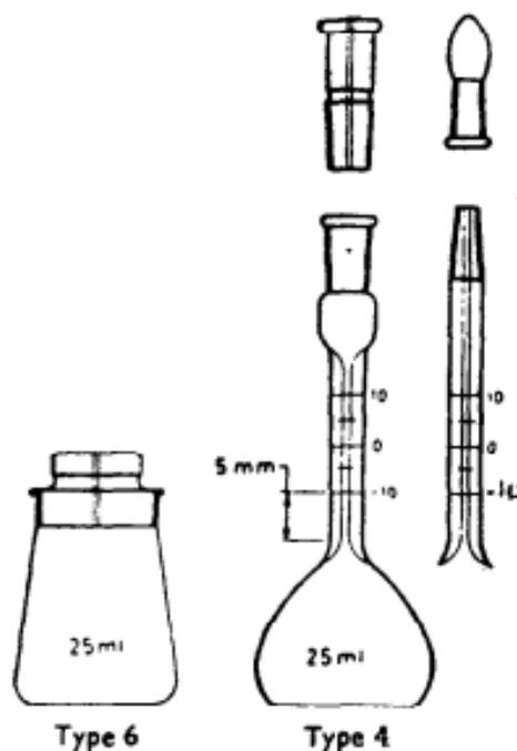
Fig. 3 Pycnometer
