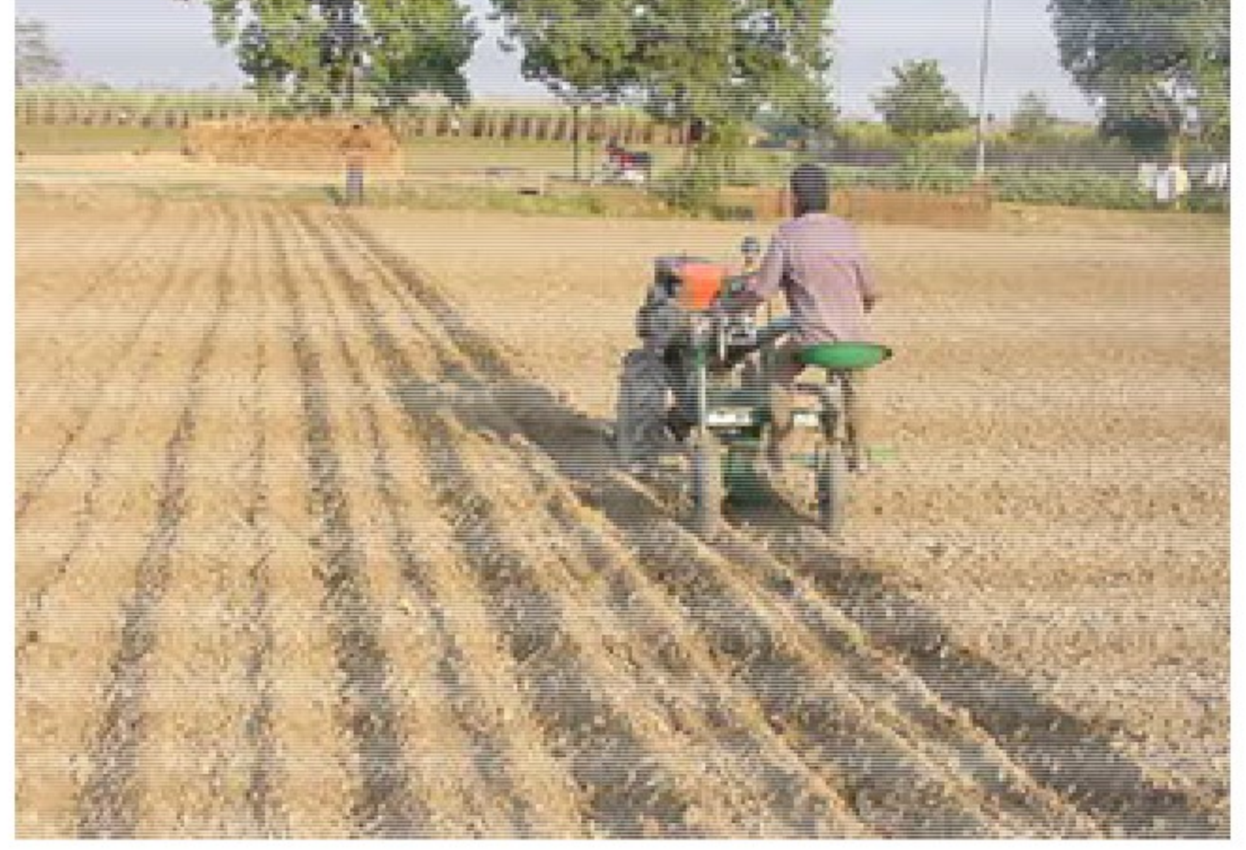
আখের নালা তৈরীতে ট্রেঞ্চার
