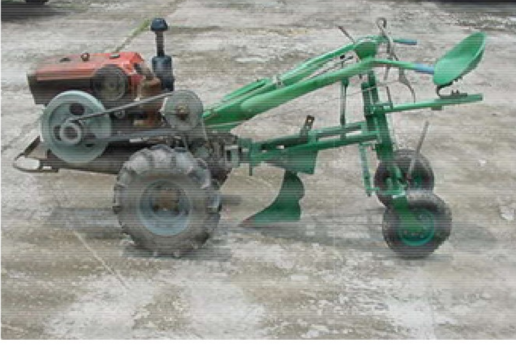
পাওয়ার টিলার মাউন্টেড ট্রেঞ্চার
