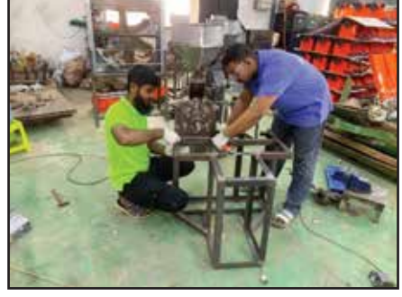
চিত্র ১৪ মেইন বেইজের সাথে ফ্লাওয়ার মিল সংযোগ করা হচ্ছে
