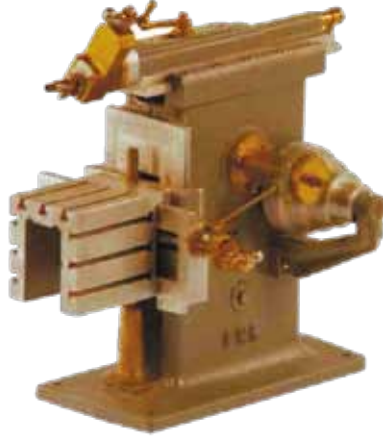
চিত্র ৪ ক্রাঙ্ক টাইপ শেপার মেশিন (Crank type)
