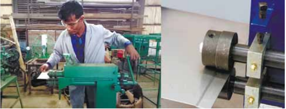
চিত্র ৪ সুয়েজিং মেশিন চালনা (Operation of swaging machine)
