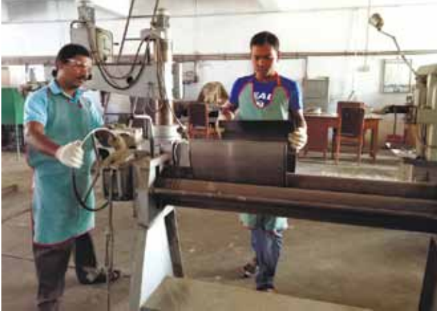
চিত্র ৩ শীট রোলিং মেশিন চালনা (Operation of sheet rolling machine)
