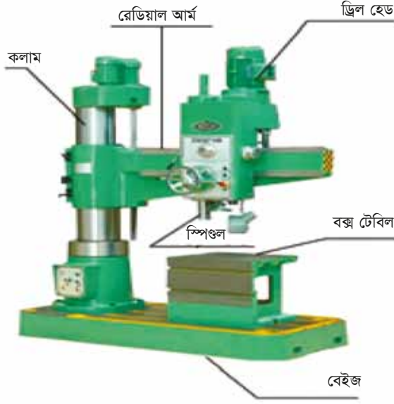
চিত্র ২ রেডিয়াল ড্রিলিং মেশিনের প্রধান অংশ (Main parts of radial drilling machine)
