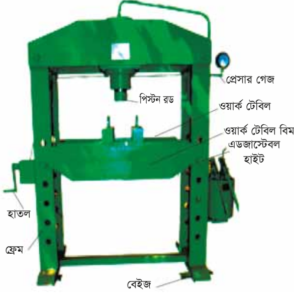
চিত্র ২ হাইড্রোলিক প্রেস মেশিনের প্রধান অংশ (Main parts of hydraulic press machine)
