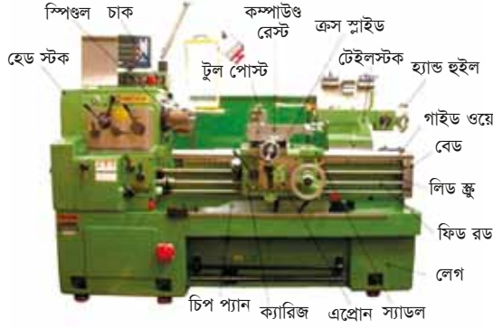
চিত্র ২ লেদ মেশিনের প্রধান অংশ (Main parts of lathe machine)
