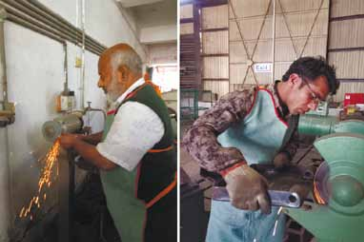
চিত্র ৩ বেঞ্চ গ্রাইন্ডার মেশিন চালনা (Operation of bench grinder machine)
