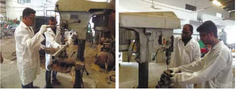
চিত্র ২ পেডেস্টাল/কলাম ড্রিলিং মেশিন চালনা (Operation of pedestal/column drilling machine)
