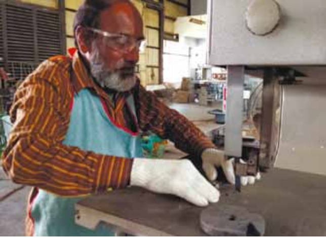
চিত্র ৩ ব্যান্ড 'স' মেশিন চালনা (Operation of band saw machine)
