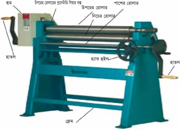
চিত্র ২ শীট রোলিং মেশিনের প্রধান অংশ (Main parts of sheet rolling machine)
