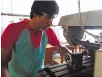
চিত্র ২৬ মিলিং মেশিন চালনা (Operation of milling machine)
