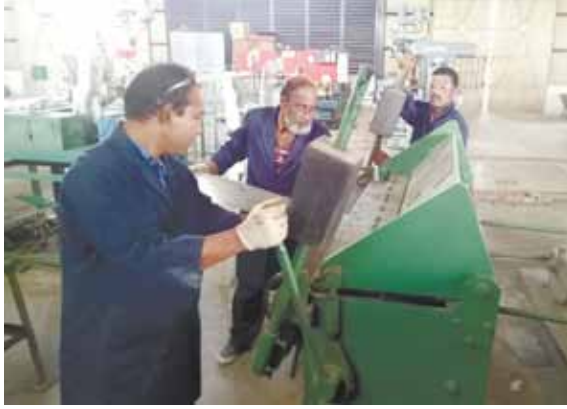
চিত্র ৩ শীট বেন্ডিং মেশিন চালনা (Operation of sheet bending machine)
