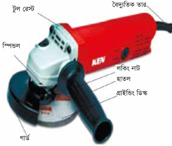
চিত্র ২ হ্যান্ড গ্রাইন্ডিং মেশিনের প্রধান অংশ (Main parts of hand grinding machine)
