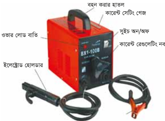
চিত্র ২ আর্ক ওয়েল্ডিং মেশিনের প্রধান অংশ (Main parts of arc welding machine)
