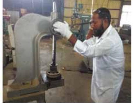
চিত্র ৩ হ্যান্ড প্রেস মেশিন চালনা (Operation of hand press machine)
