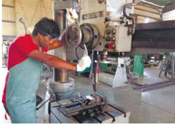
চিত্র ৩ রেডিয়াল ড্রিলিং মেশিন চালনা (Operation of radial drilling)
