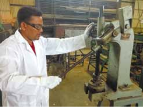
চিত্র ৩ হ্যান্ড প্রেস মেশিন চালনা (Operation of hand press machine)
