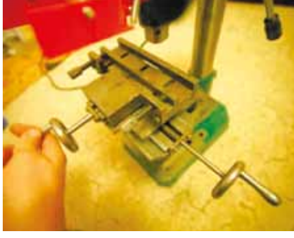
চিত্র ৩ হ্যান্ড মিলিং মেশিন (Hand milling machine)
