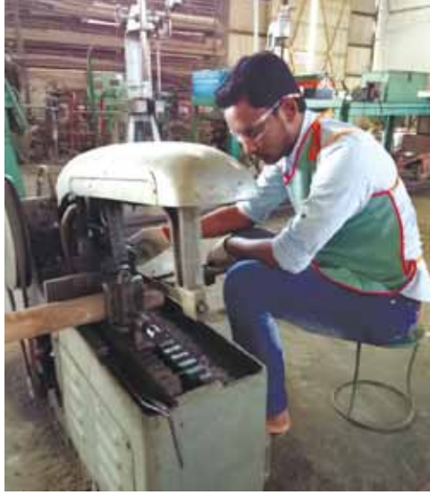
চিত্র ৩ পাওয়ার 'স' মেশিন চালনা (Operation of power saw machine)
