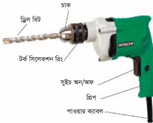
চিত্র ২ হ্যান্ড ড্রিলিং মেশিনের প্রধান অংশ (Main parts of hand drilling machine)
