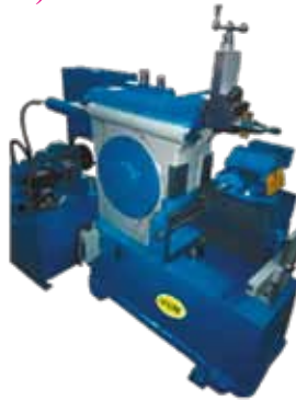
চিত্র ৫ হাইড্রোলিক টাইপ শেপার মেশিন (Hydraulic type)
