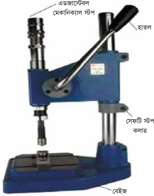
চিত্র ২ হ্যান্ড প্রেস মেশিনের প্রধান অংশ (Main parts of hand press machine)
