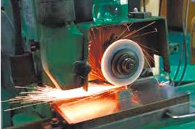
চিত্র ৩ সারফেস গ্রাইন্ডিং মেশিন চালনা (Operation of surface grinding machine)
