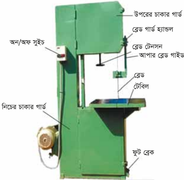
চিত্র ২ ব্যান্ড 'স' মেশিনের প্রধান অংশ (Main parts of band saw machine)
