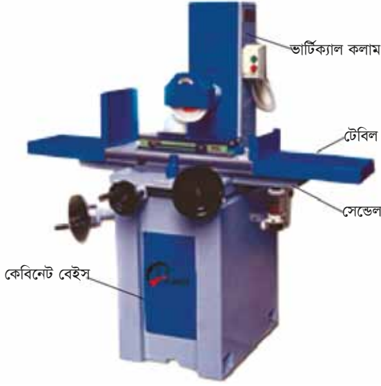
চিত্র ২ সারফেস গ্রাইন্ডিং মেশিনের প্রধান অংশ (Main parts of surface grinding machine)
