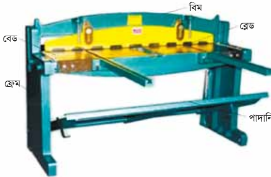
চিত্র ২ পা-চালিত শীট কাটার মেশিনের প্রধান অংশ (Main parts of foot operated sheet cutter machine)
