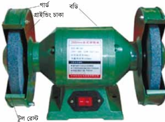
চিত্র ২ বেঞ্চ গ্রাইন্ডার মেশিনের প্রধান অংশ (Main parts of bench grinder)
