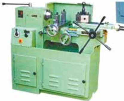
চিত্র ৭ ক্যাপস্টেন লেদ (Capstan lathe)
