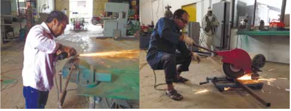
চিত্র ৩ হ্যান্ড গ্রাইন্ডিং মেশিন চালনা (Hand grinding machine operation)
