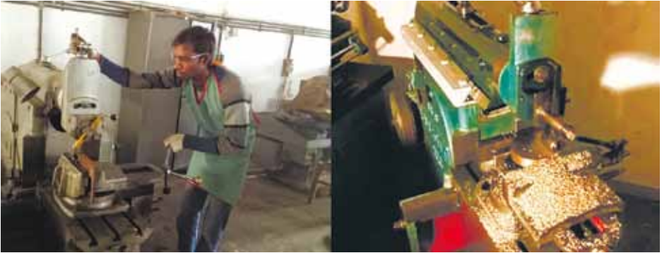
চিত্র ১১ শেপার মেশিন চালনা (Operation of shaper machine)
