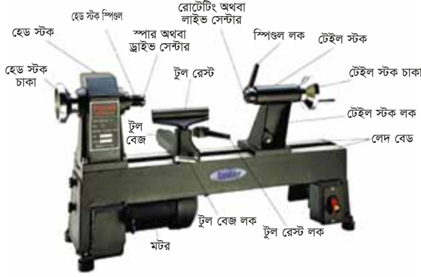
চিত্র ২ উড লেদের প্রধান অংশ (Wood lathe)
