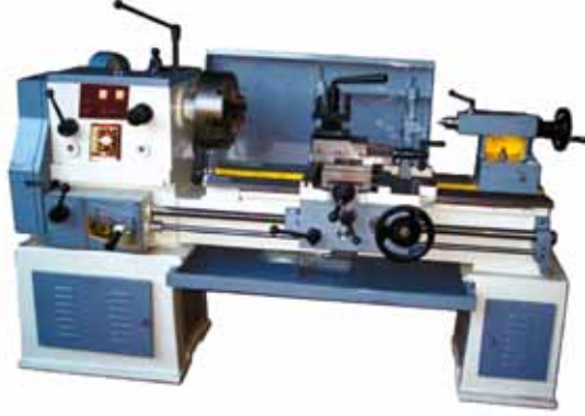
চিত্র ১ লেদ মেশিন (Lathe machine)
