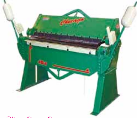
চিত্র ১ শীট বেন্ডিং মেশিন (Sheet bending machine)
