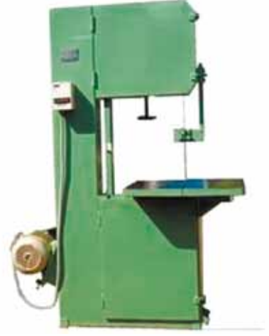
চিত্র ১ ব্যান্ড 'স' মেশিন (Band saw machine)
