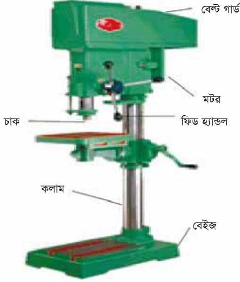
চিত্র ১ পেডেস্টাল/কলাম ড্রিলিং মেশিনের প্রধান অংশ (Main parts of pedestal/column drilling machine)
