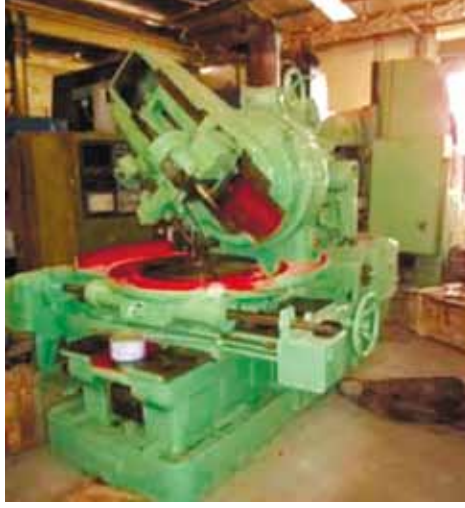
চিত্র ১০ ইউনিভার্সাল শেপার মেশিন (Universal shaper machine)
