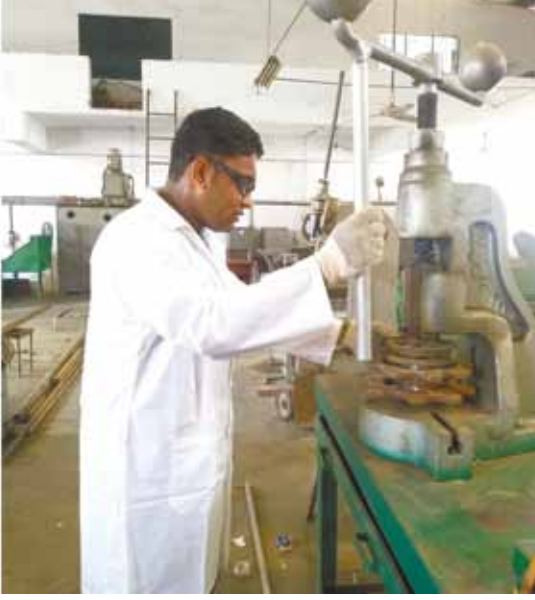
চিত্র ৩ ফ্লাই প্রেস মেশিন চালনা (Operation of fly press machine)
