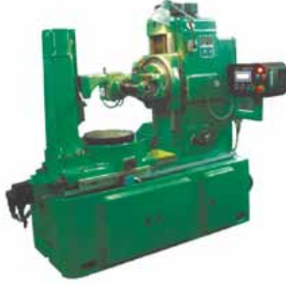
চিত্র ১০ গিয়ার হবিং মেশিন (Gear hobbing machine)
