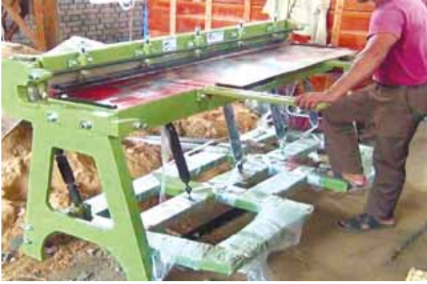
চিত্র ৩ পা-চালিত শীট কাটার মেশিনের প্রধান অংশ (Main parts of pedal operated sheet cutter)
