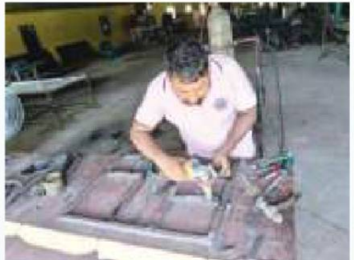
চিত্র ৬ চেইন টেনশনার গ্রাইন্ডিং করা
