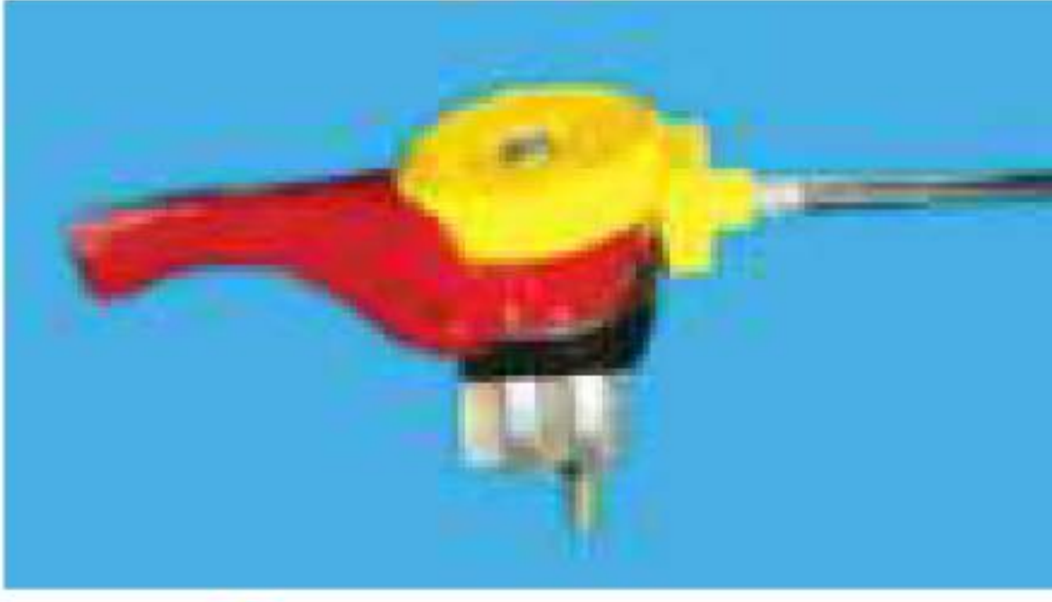
চিত্র ৪৯ এক্সেলেটর লিভার
