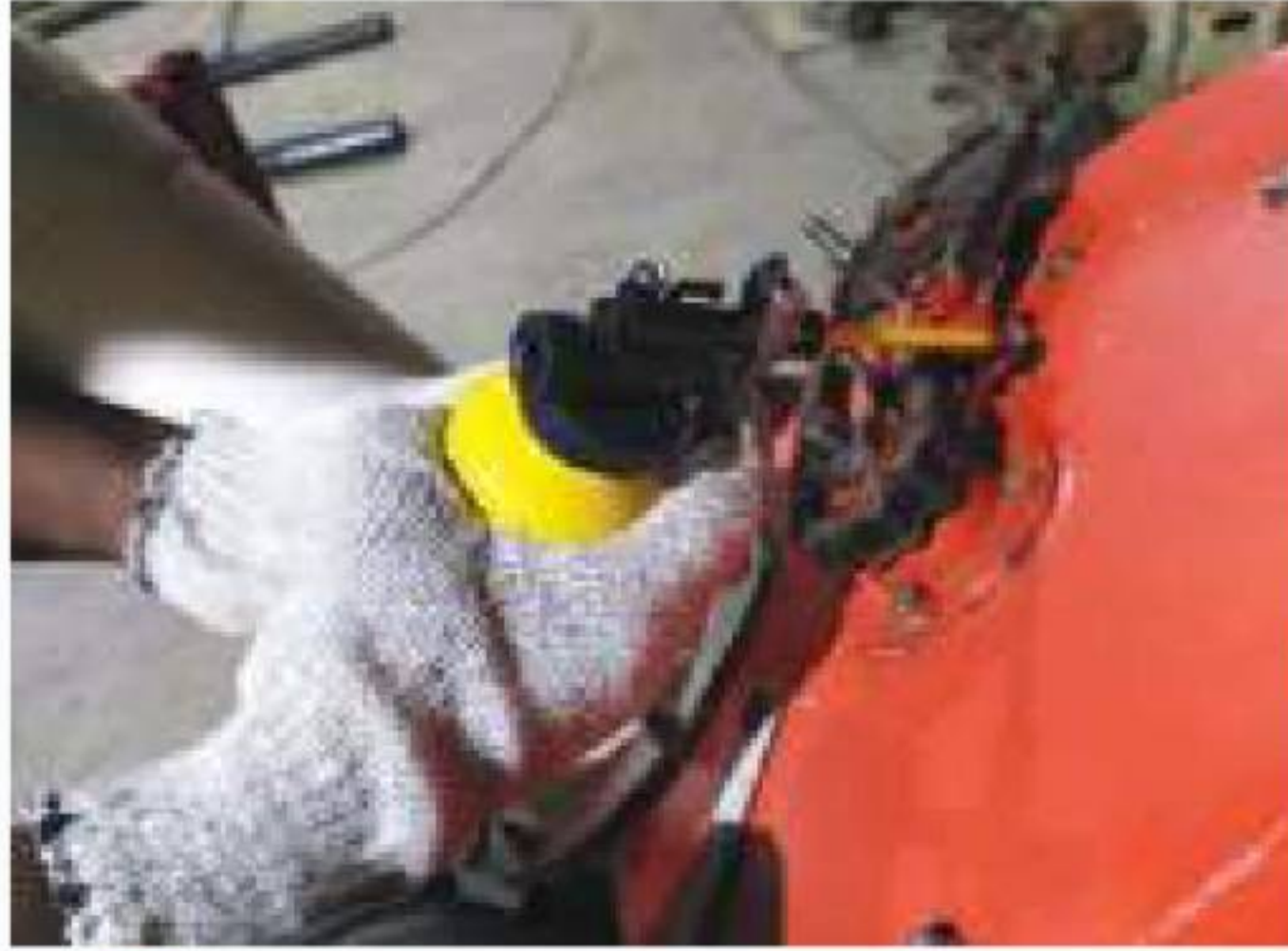
চিত্র ২ চেইন টেনশন রোলারে লুব্রিকেশন করা
