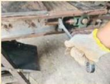
চিত্র ১২: কনভেয়ার বেল্টের টেনশন সমন্বয়
