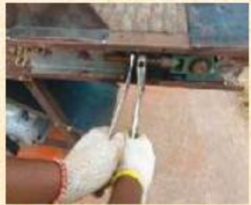
চিত্র ১২: কনভেয়ার বেল্টের টেনশন সমন্বয়
