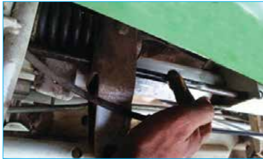
চিত্র ৩৬ যন্ত্র উচু এবং নিচু করার জন্য দুই পাশের রাউন্ড শ্যাফট
