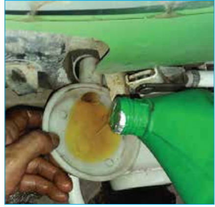
চিত্র ৫ ট্রান্সমিশন অয়েল ভরা
