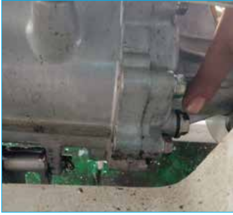
চিত্র ৪ ট্রান্সমিশন অয়েল ড্রেন আউট করা
