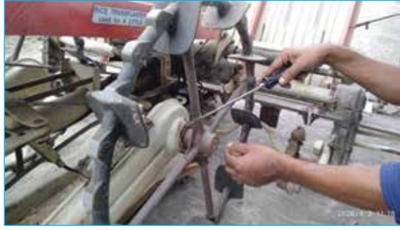
চিত্র ১৪ চেইন ছেড়া বা লক নষ্ট
