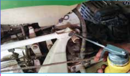
চিত্র ৩১ যন্ত্রকে উচু এবং নিচু করার বুশ টাইপ পিনগুলোতে ওয়েল দেয়া
