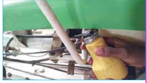
চিত্র ৩১ যন্ত্রকে উচু এবং নিচু করার বুশ টাইপ পিনগুলোতে ওয়েল দেয়া
