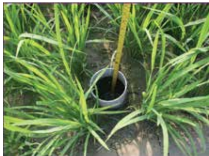
চিত্র ১৫। এডব্লিউডি পদ্ধতিতে পাইপে পানি পর্যবেক্ষণ।
