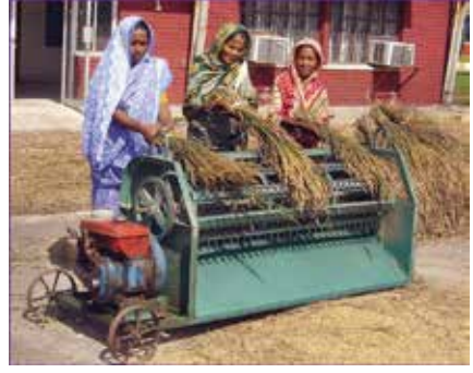
চিত্র ৬৯। ব্রি ওপেন ড্রাম পাওয়ার থ্রেসার।
