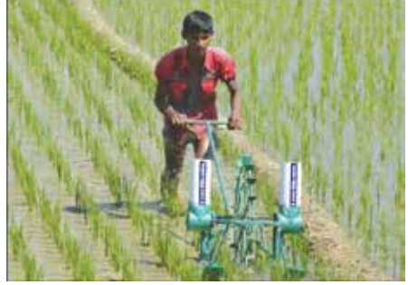
চিত্র ৬১। ব্রি দানাদার ইউরিয়া প্রয়োগ যন্ত্র।
