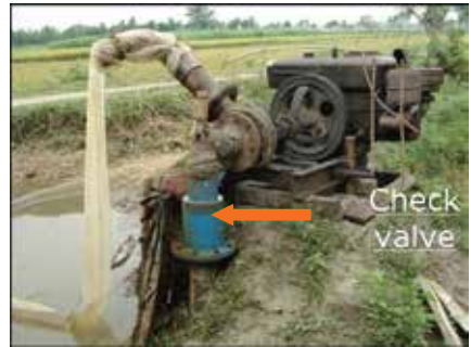
চিত্র ১২। অগভীর নলকূপে চেক ভাল্বের ব্যবহার।
