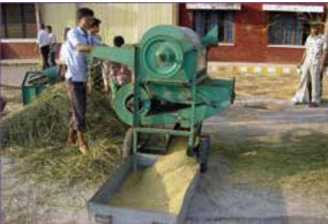
চিত্র ৭০। ব্রি ধান-গম পাওয়ার থ্রেসার।
